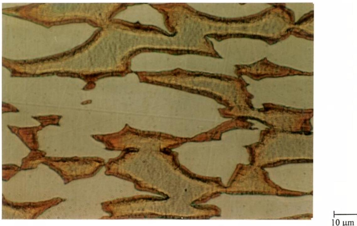
Figura 4.3. Detalhe da microestrutura do material como recebido. Ataque: 10% KOH (eletrolítico).
