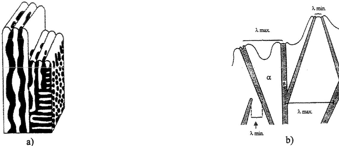
Figura 2.5. Estrutura esquemática dos eutéticos metaestável [Stefanescu, 1988] e estável [Magnim, 1988].
