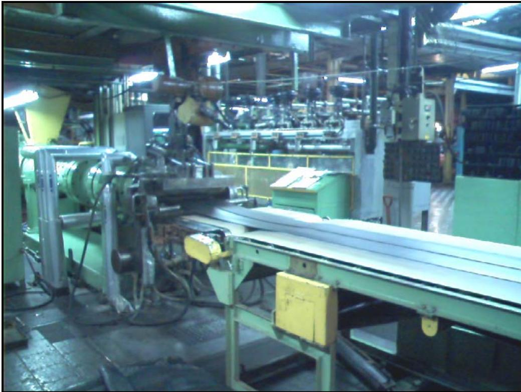
Figura 3.34 – Máquina Laminadora.
