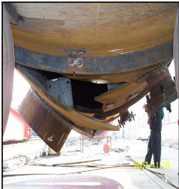
Figura 2.13 – Explosão de vaso durante teste hidrostático 1.
