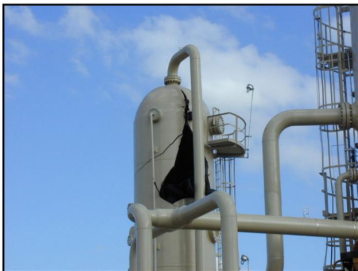
Figura 2.11 – Acidente em teste hidrostático.
