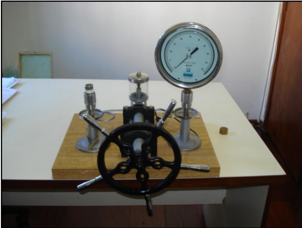
Figura 3.16 – Manômetro padrão instalado em uma balança comparadora hidráulica.
