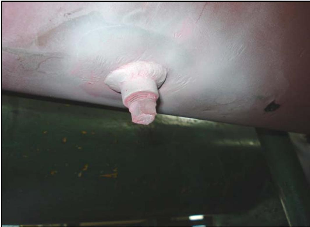
Figura 3.53 – Revelação do LP na Solda do respiro de um trocador de calor.
