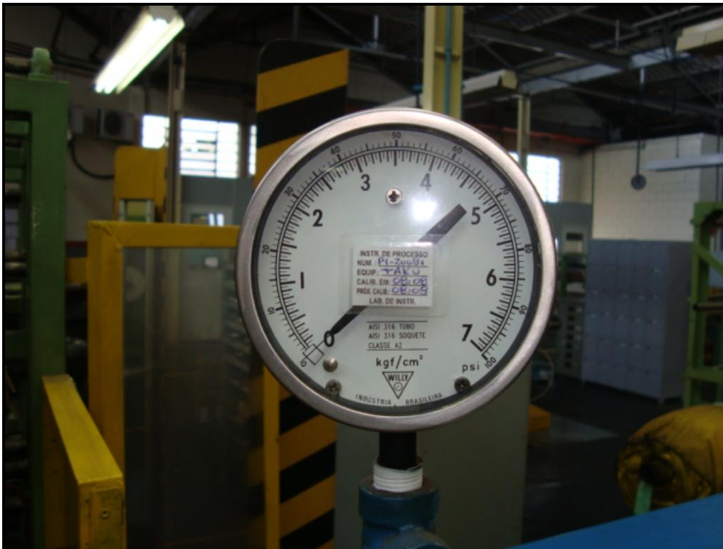
Figura 3.17 – Manômetro Calibrado.
