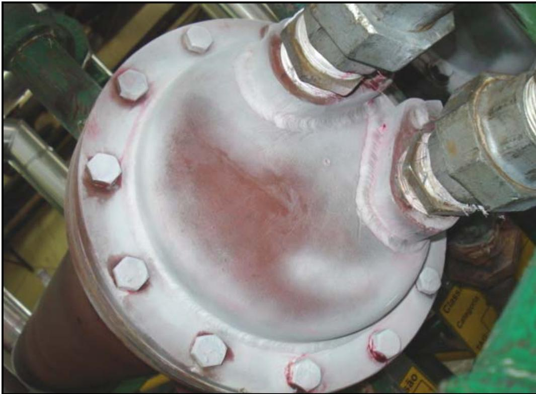
Figura 3.52 – Revelação do LP nas Soldas do cabeçote de um trocador de calor.
