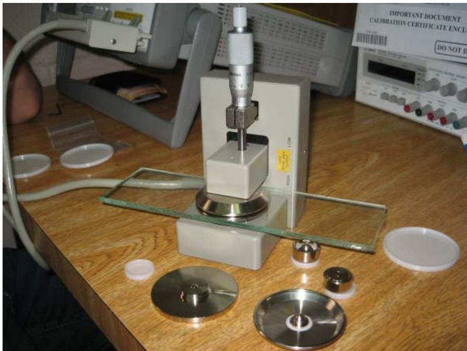
Figura 3.11.- Dielectric Test Fixture.
