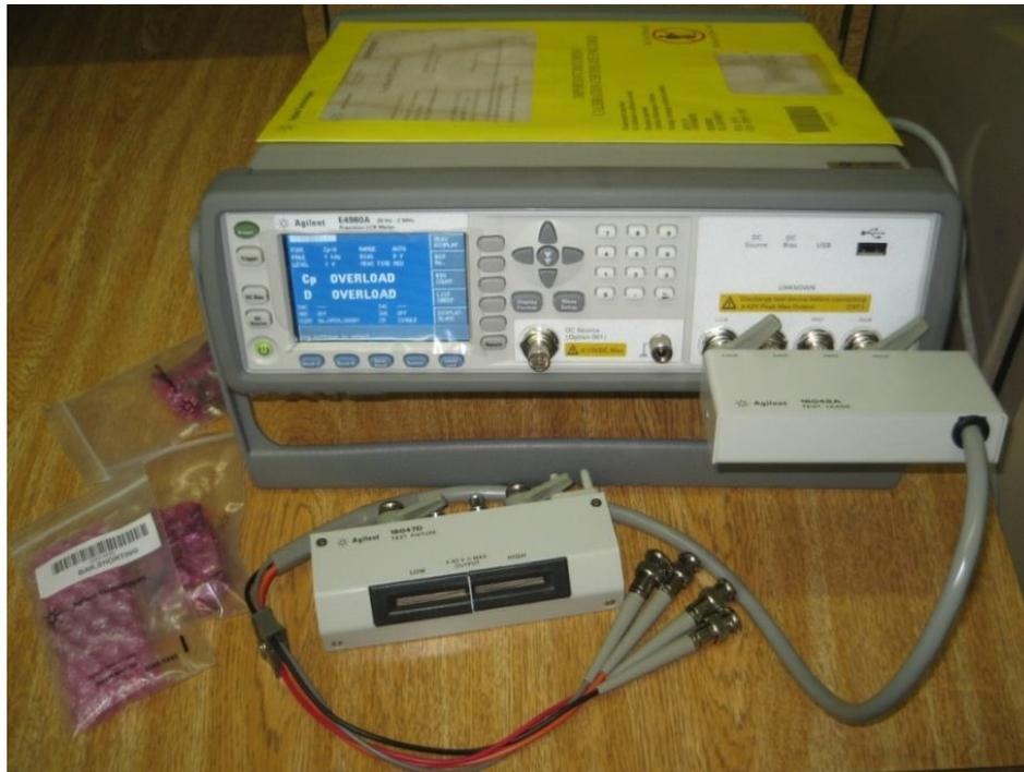
Figura 3.10.- E4980A Precision LCR Meter.
