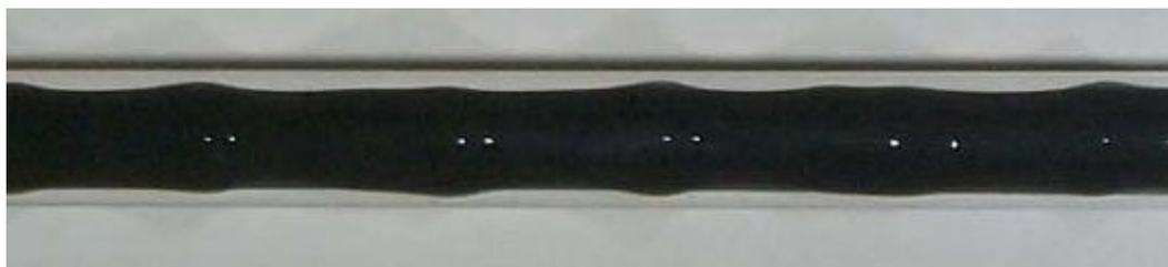
Figura 2.1- Escoamento horizontal *core-flow*.
