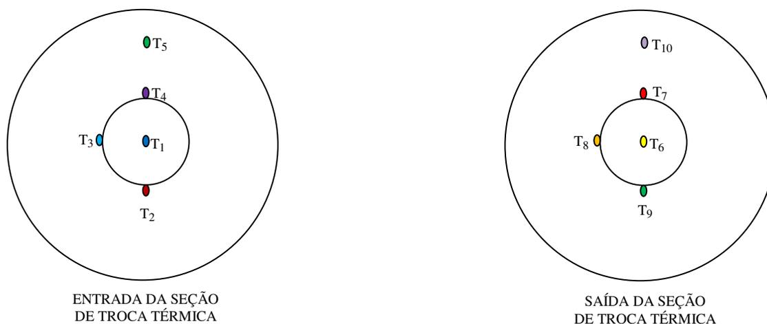
**Figura 3.17:** Vista frontal da localização dos termopares.
