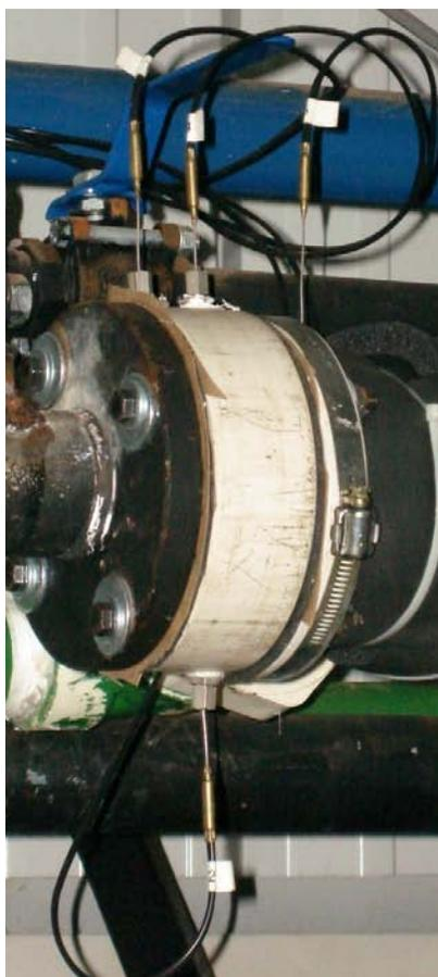
**Figura 3.19:** Foto dos termopares instalados no flange de entrada.
