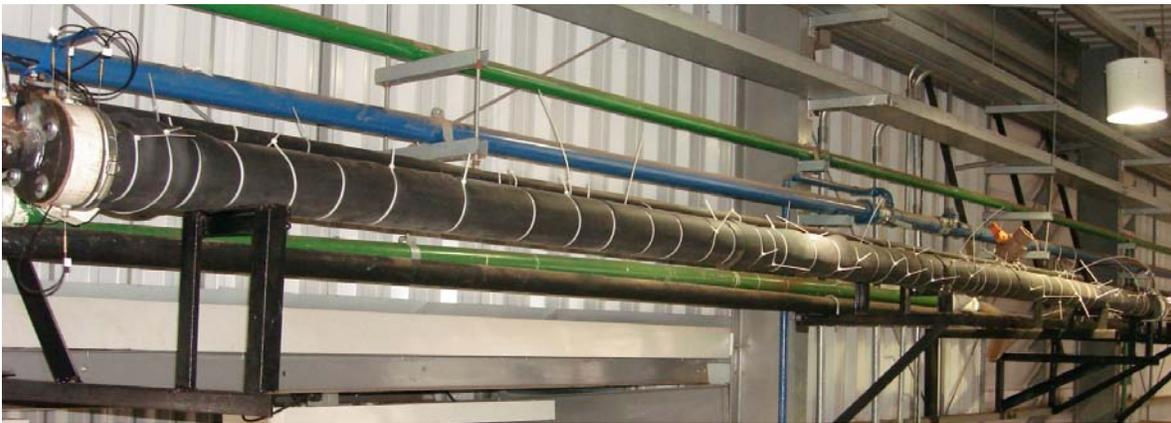
**Figura 3.11:** Sistema de troca térmica instalado.
