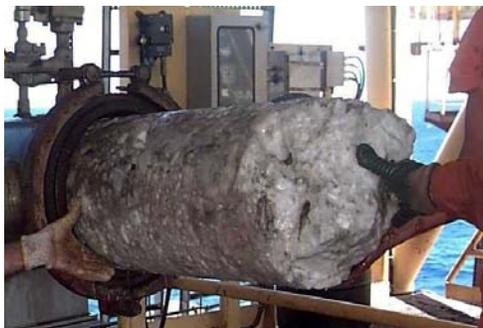
**Figura 1.6:** Bloqueio do duto por formação de hidratos.
