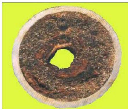
**Figura 1.7:** Bloqueio do duto por deposição de parafina.
