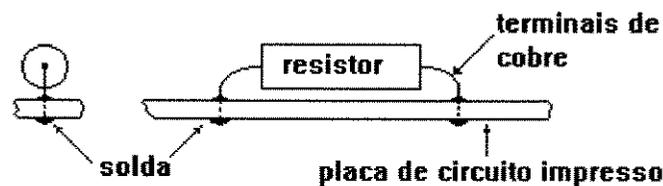
Figura 4.4 - Montagem do resistor na placa de circuito impresso.
