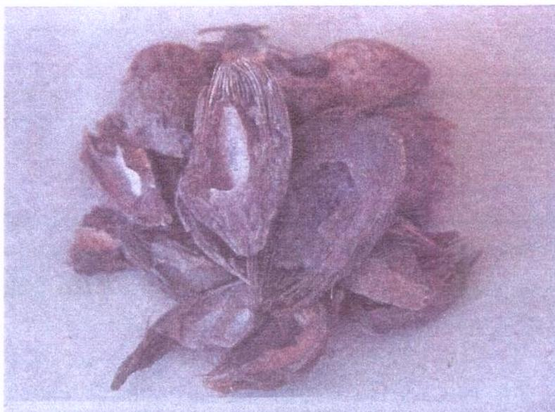
Figura 19: Endocarpo de Babaçu quebrado mecanicamente, fornecido pelo Sr. José Mário F. Frazão (Frazão, 2001).
