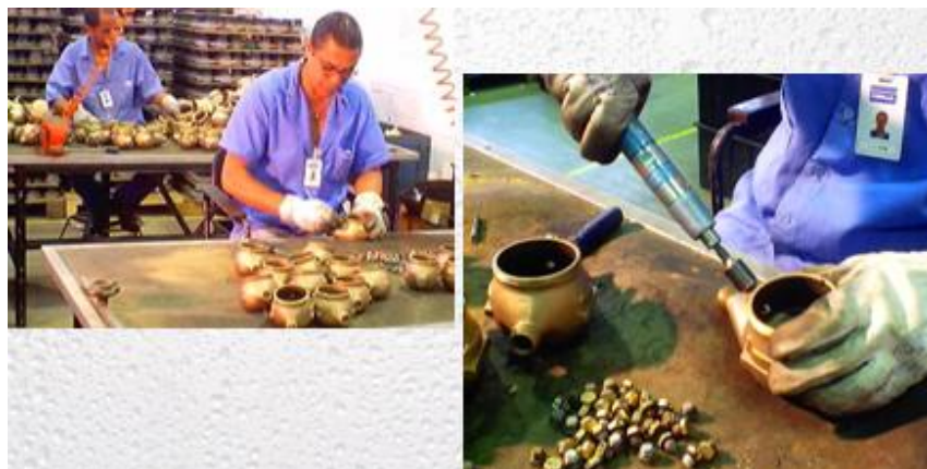
Figura 4.23: Rebarbação manual de carcaças
