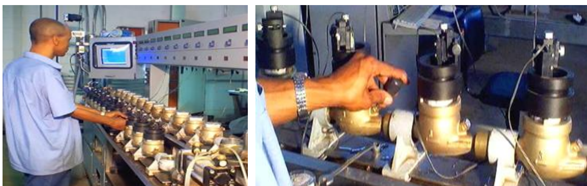
Figura 4.53: Bancada de aferição eletrônica de hidrômetro
