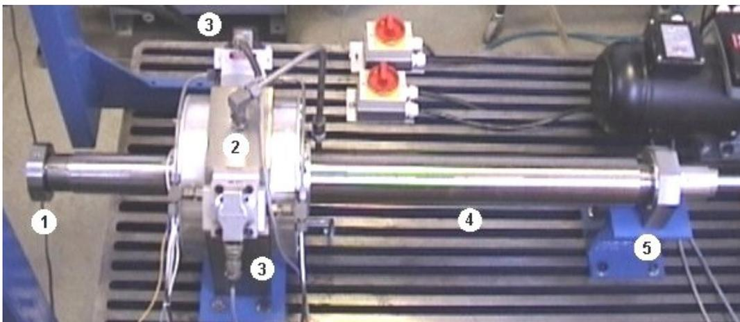
**Figura 3.8:** Bancada de testes da DTU: 1. mancal de excitação; 2. mancal segmentado ativo; 3. servoválvulas; 4. eixo; 5. mancal de rolamento.
