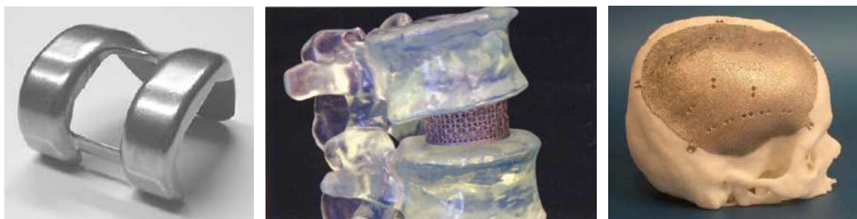
Figura 4.8 – Exemplos de próteses obtidas por processo de EBM (www.arcam.com).
