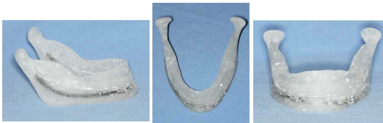
Figura 7.18– Aspecto final da prótese total de mandíbula de PMMA, hidroxiapatita e núcleo de fibra de carbono.
