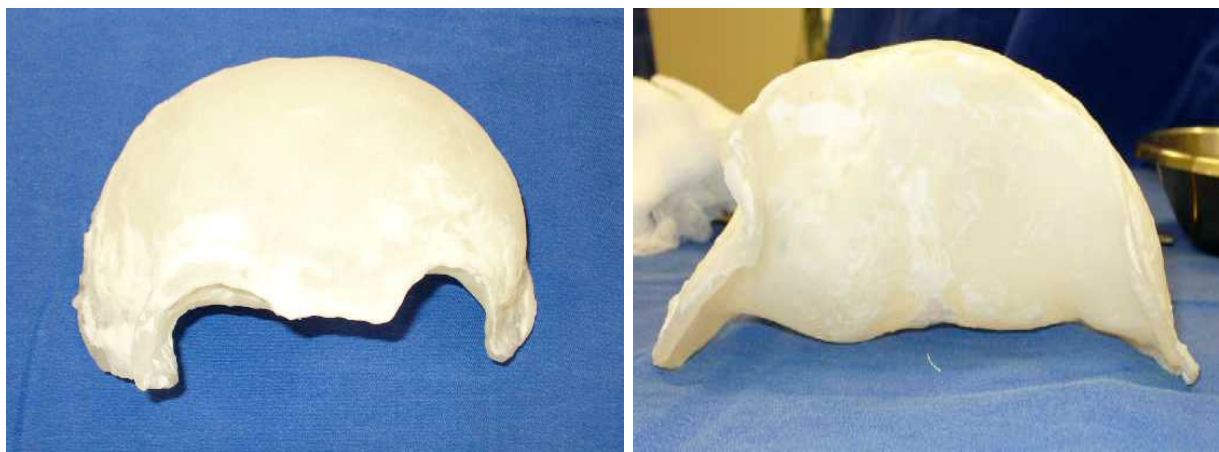
Figura 7.55 – Aspecto final da prótese volumétrica confeccionada em PMMA.
