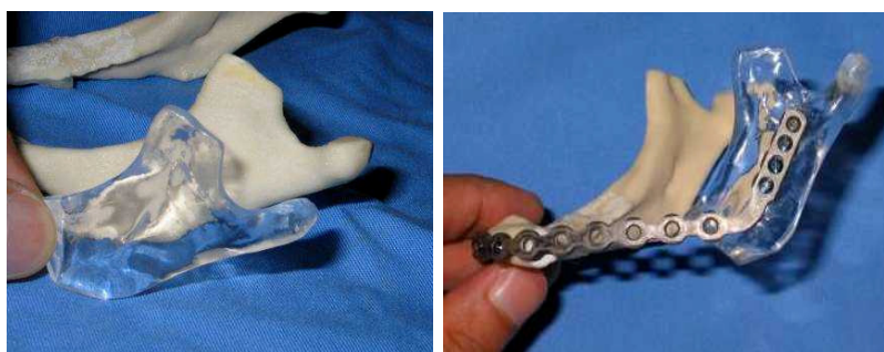
Figura 7.12 – Obtenção da prótese de PMMA e placa de titânio para reconstrução mandibular.
