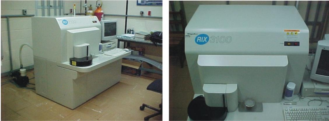
**Figura 3.11** - Espectrômetro de fluorescência de raios X, modelo Rigaku RIX 3100.
