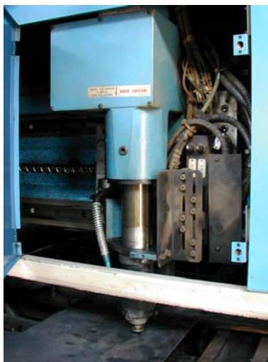
**Figura 3.18** -. Sistema do cabeçote por onde o feixe laser é emitido
