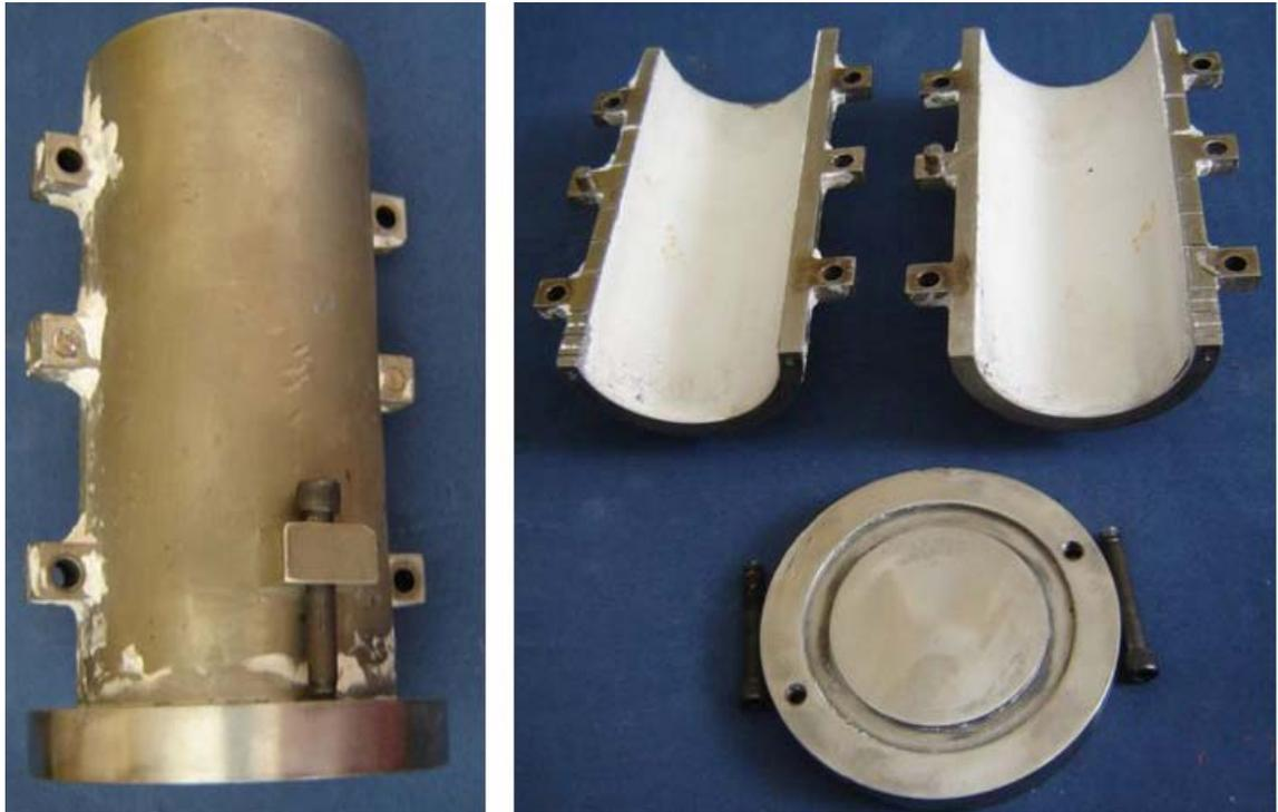
**Figura 3 13** - Lingoteira de aço inoxidável 310 com dimensões de 60 mm de diâmetro interno e comprimento de 160 mm.
