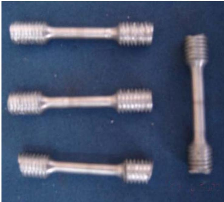
**Figura 3.20** – Corpos-de-provas utilizados nos ensaios de tração
