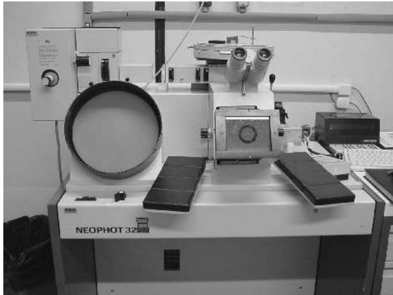
**Figura 3. 24** - Microscópio óptico Neophot – 32
