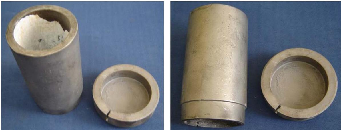
**Figura3.14** - Lingoteira de aço inoxidável 310 com dimensões de 50 mm de diâmetro interno e comprimento de 110 mm
