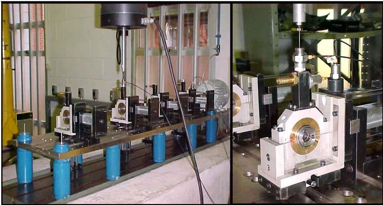
Figura 7.6: Montagem e distribuição dos mancais hidrodinâmicos na fundação rígida.
