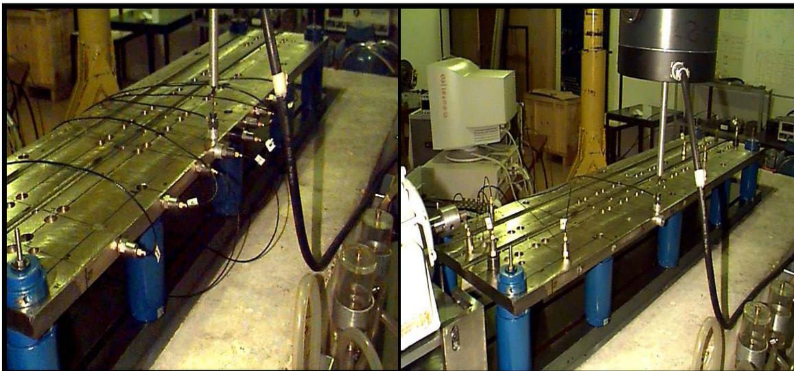
Figura 7.4: Fundação rígida excitada verticalmente, respostas medidas nas direções horizontal e vertical.
