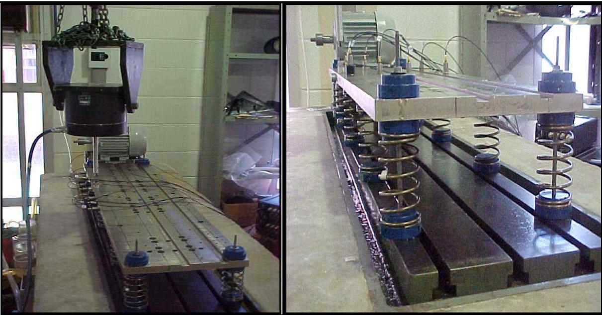
Figura 7.2: Fundação Flexível excitada verticalmente, respostas medidas nas direções horizontal e vertical.
