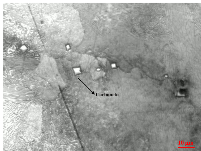
Figura 4.9 – Carbonetos encontrados na matriz da liga L2 atacada com Nital 1%.
