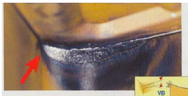
Figura 3.6– Desgaste de flanco na aresta de corte de uma pastilha (SANDVIK, 2005).
