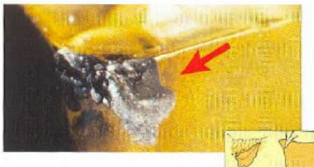
Figura 3.11 - Quebra de aresta da pastilha de corte (SANDVIK, 2005).
