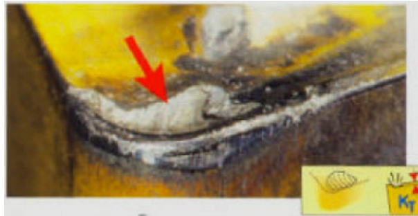
Figura 3.7 – Desgaste de cratera na aresta de corte de uma pastilha (SANDVIK, 2005).
