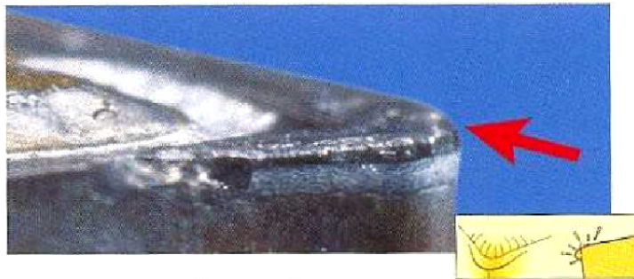
Figura 3.9 – Deformação plástica na aresta de corte (SANDVIK, 2005).
