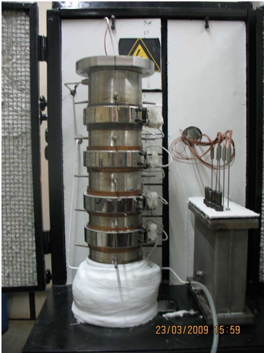
Figura 7. Jaqueta de vácuo e célula SAGD
