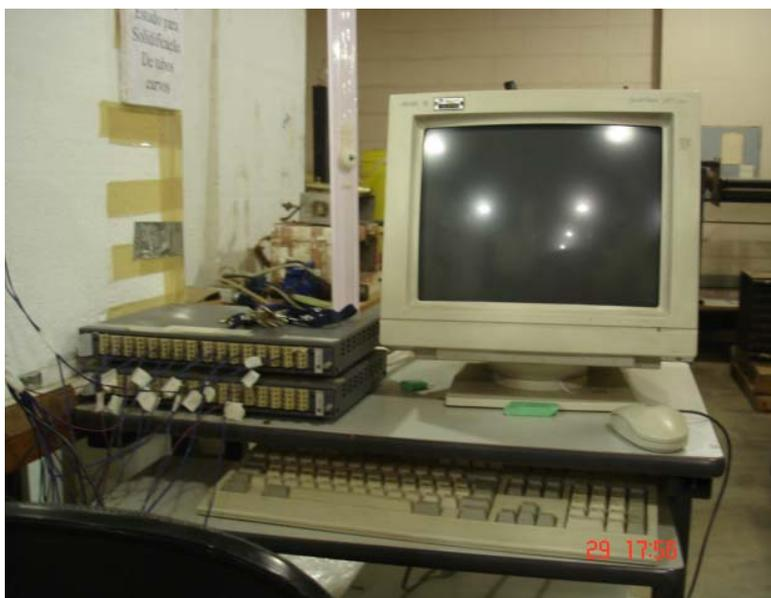
**Figura 3.9 – Fotografia do sistema de aquisição de dados da marca LYNX**
