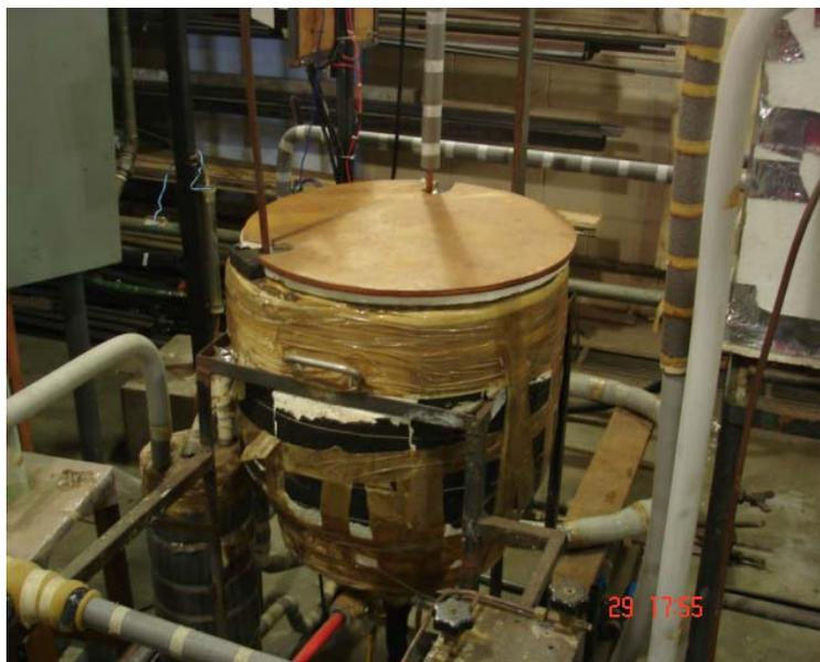
**Figura 3.3 – Fotografia do reservatório do fluido secundário**
