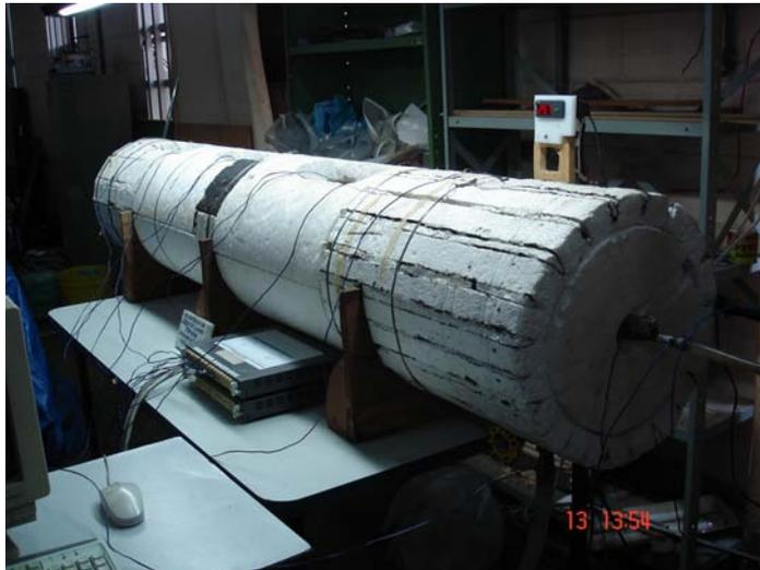
Figura 3.1 – Trocador de Calor: tubo externo isolado e tubo interno de cobre
