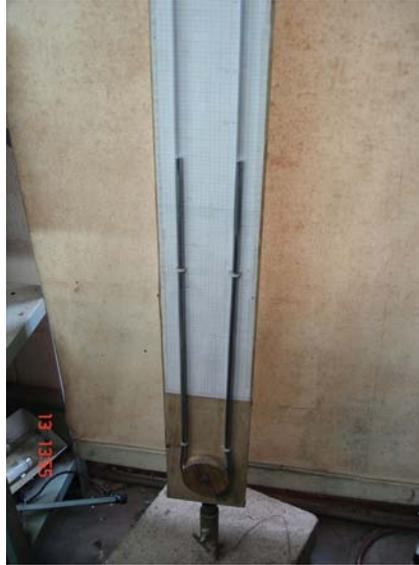
Figura 3.4 – Manômetro em “U” utilizado
