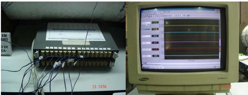
Fotografia 3.6 – Placa de Aquisição com 30 canais e interface do programa AQDADOS
