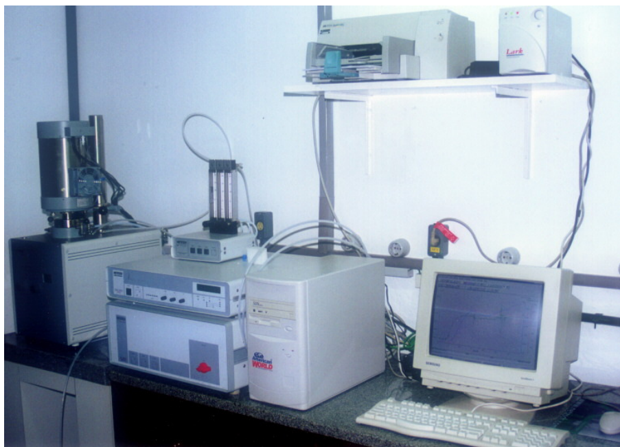
Figura 3.5: Equipamento utilizado para análises de DSC (STA 409C marca Netzsch)
