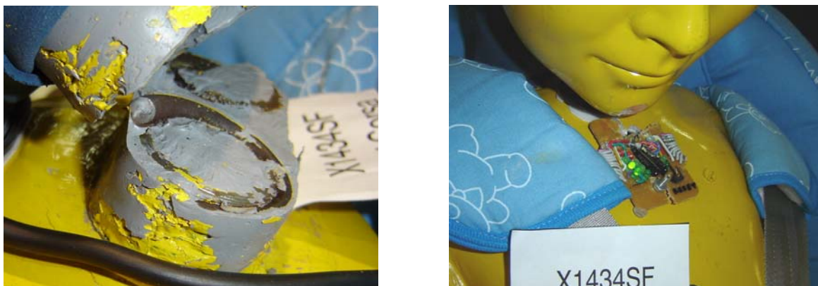
Figura 25 (a e b): Danos ao pescoço e ao painel
