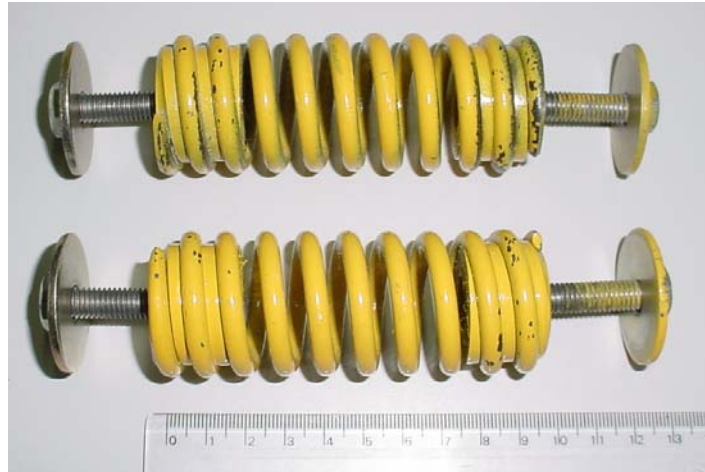
Figura 11: Molas utilizadas no pescoço
