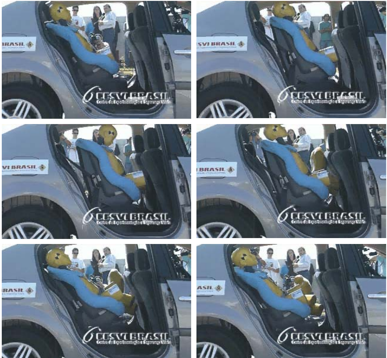
Figura 20 (a - f): Comportamento do boneco e da cadeirinha com o impacto
