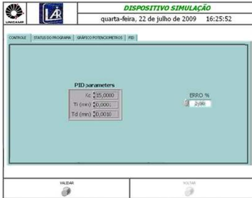
Figura 4.22: Tela de Ajuste de Parâmetros do Controlador PID
