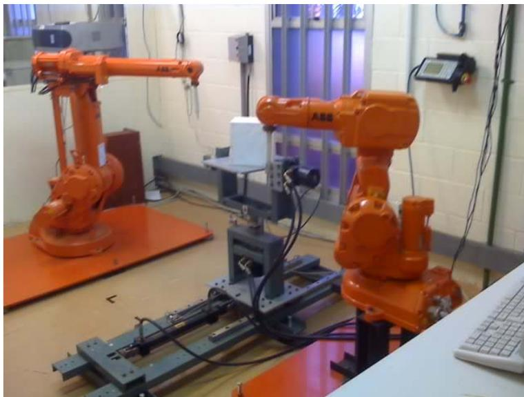
Figura 3.4: Célula Flexível de Manufatura
