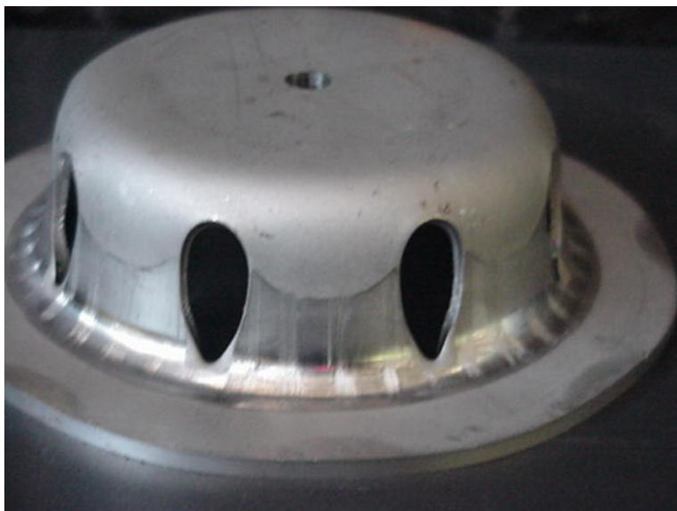
Figura 44 – Corpo de prova embutido a partir do blanque de 165 mm, com raio de matriz/punção de 8 mm com a atuação do prensa chapa.
