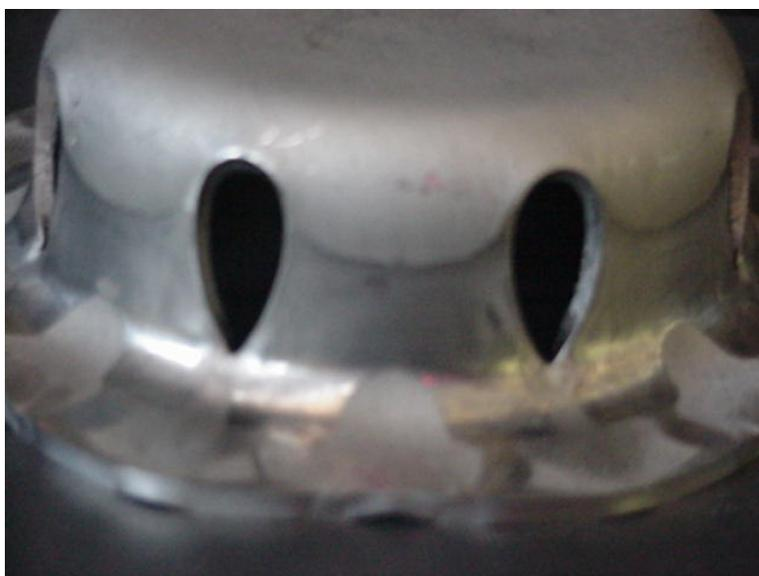
Figura 45 – Corpo de prova embutido a partir do blanque de 165 mm, com raio de matriz/punção de 8 mm sem a atuação do prensa chapa.
