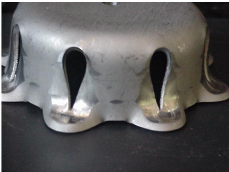
Figura 50 – Corpo de prova embutido a partir do blanque de 135 mm com região da aba comprometida.
