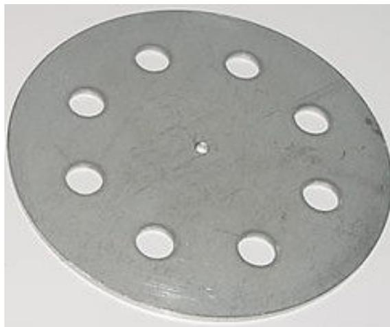
Figura 14 – Blanche com oito furos de diâmetro 15,3 mm no diâmetro médio de 108 mm.
