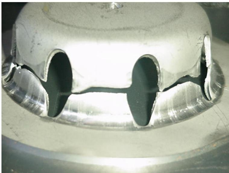
Figura 46 – Corpo de prova embutido a partir do blanque de 175 mm, com raio de matriz/punção de 6 mm com a atuação do prensa chapa.
