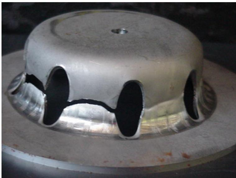
Figura 48 – Corpo de prova embutido a partir do blanque de 175 mm, com raio de matriz/punção de 8 mm com a atuação do prensa chapa.
