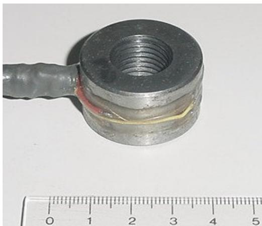
Figura 19 – Fotografia transdutor de força preparado com extensômetros elétricos.
