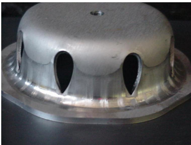
Figura 53 – Corpo de prova embutido a partir do blanque de 155 mm sem fratura. Ensaio com nenhum corpo de prova fraturado.
