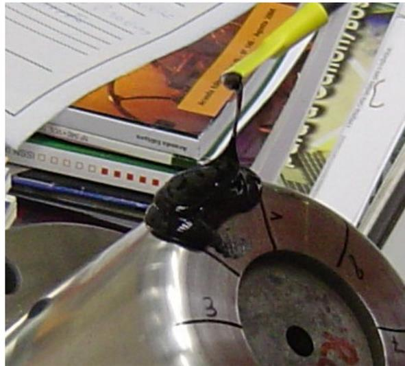
Figura 24 – Aplicação do silicone para réplica da textura do raio do punção
