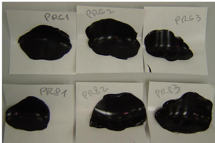
Figura 28 – Fotos das réplicas de silicone dos raios do punção.
