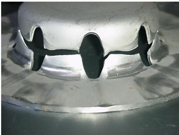
Figura 52 – Corpo de prova embutido a partir do blanque de 185 mm. Ensaio com todos os corpos de prova fraturados.
