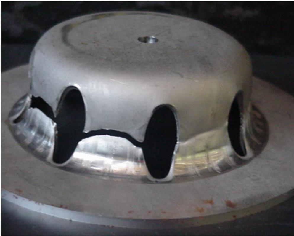
Figura 1 – Peça com fratura após estampagem
