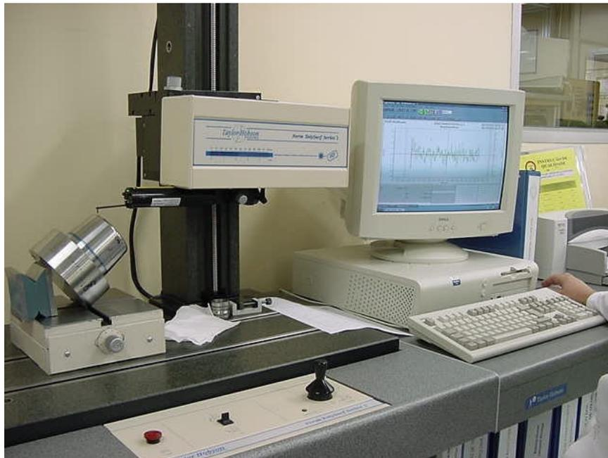
Figura 12 – Rugosímetro de raio “Form TalySurf Series 2 PGI - Taylor Robson Pneumo”
