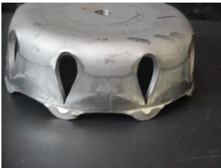
Figura 51 – Corpo de prova embutido a partir do blanque de 145 mm com região da aba comprometida.
