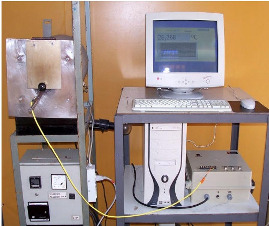
Figura 3.3: Forno resistivo e sistema de aquisição de dados utilizados nos tratamentos térmicos de globularização.
