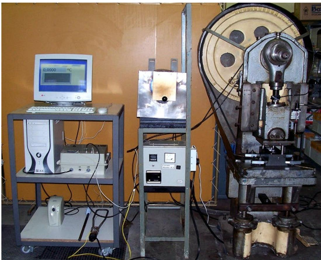
Figura 3.6: Conjunto de equipamentos utilizados na realização dos ensaios de tixoforjamento.
