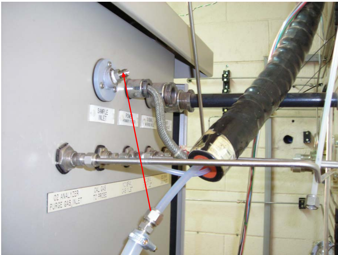
Figura 3.2 Conexão para calibração do Spam
