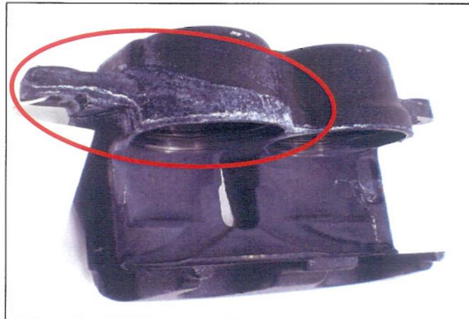
Figura 5.18. Peça nº 3 antes do ensaio de corrosão acelerada em névoa salina.
