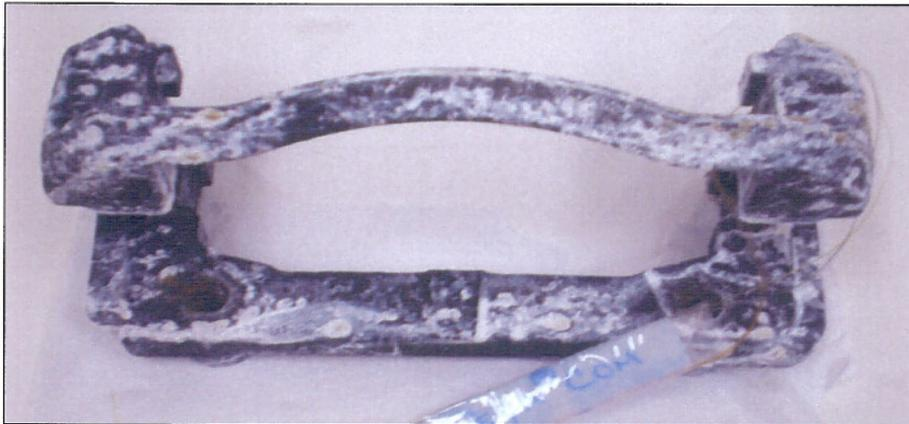
Figura 5.15. Peça nº 2 após 48 horas de ensaio de corrosão acelerada em névoa salina.
