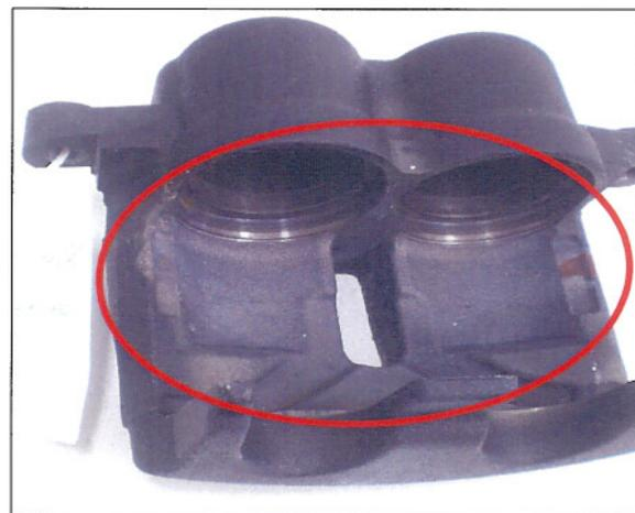
Figura 5.22. Peça nº 4 antes do ensaio de corrosão acelerada em névoa salina.
