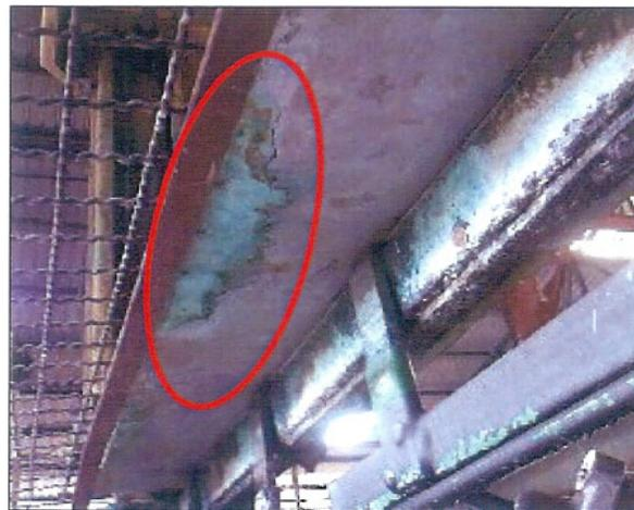
Figura 5.21. Calha de proteção do barramento anódico danificada, causando respingos na Peça nº 3
