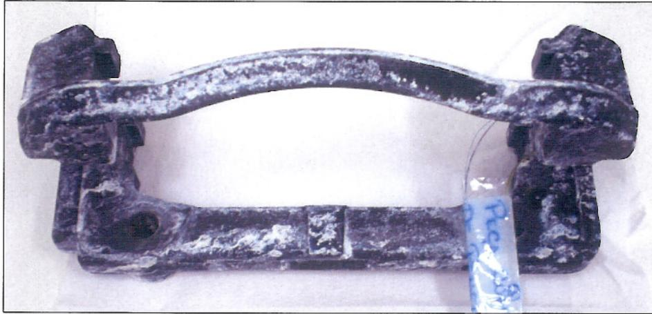
Figura 5.11. Peça nº 1 após 48 horas de ensaio de corrosão acelerada em névoa salina.
