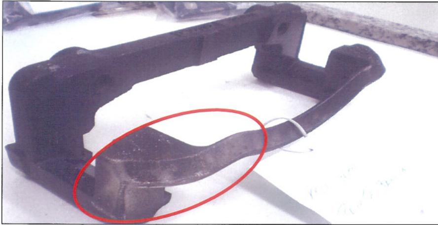
Figura 5.14. Peça nº 2 antes do ensaio de corrosão acelerada em névoa salina.
