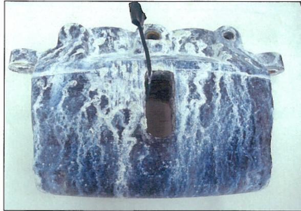
Figura 5.20. Peça nº 3 após 504 horas de ensaio de corrosão acelerada em névoa salina.
