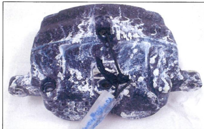
Figura 5.19. Peça nº 3 após 48 horas de ensaio de corrosão acelerada em névoa salina.
