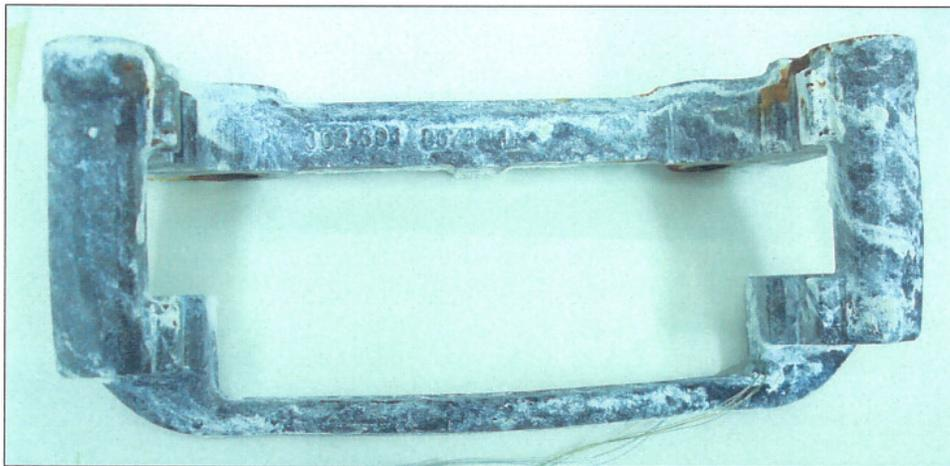
Figura 5.12. Peça nº 1 após 504 horas de ensaio de corrosão acelerada em névoa salina.
