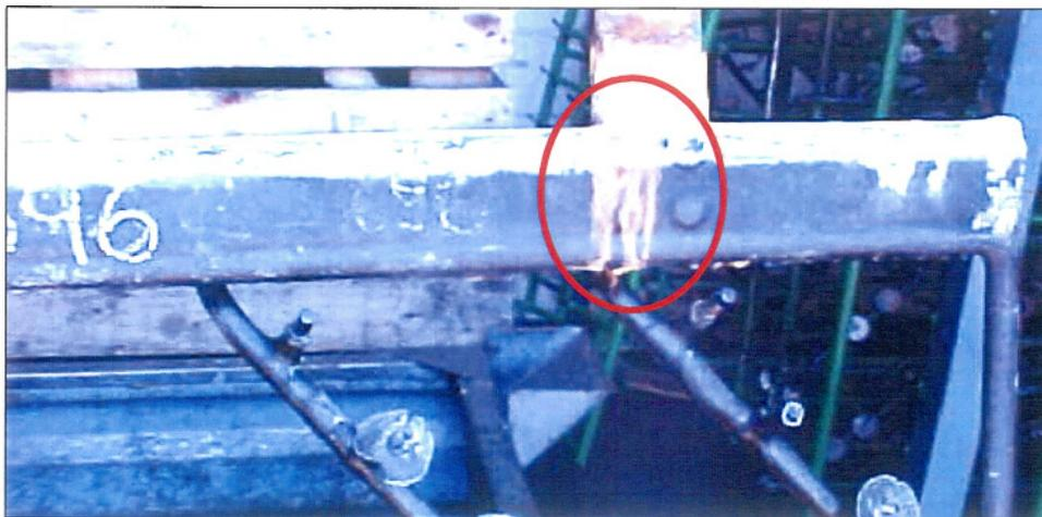
Figura 5.13. Gancheira danificada que causou o respingo sobre a peça nº 1.
