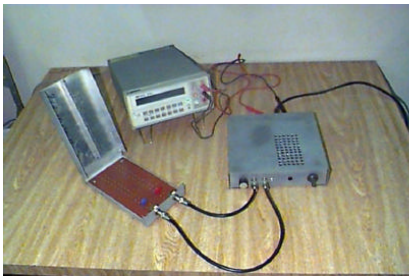
Figura 3.28 - Bancada de calibração dos transdutores de capacitância
