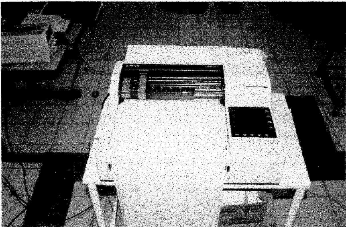
Figura 3.4. Registrador de temperatura do LTT-DEMA/UNICAMP.
