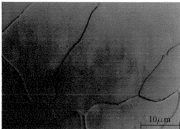
Figura 4.17. Microestrutura do aço UBC Ti-IF na condição como fornecido. Ataque: nital 3%. Aumento. 500X.
