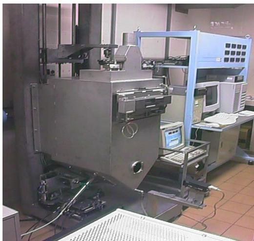
**Figura 3-6.** Câmara de deposição VAD piloto industrial.
