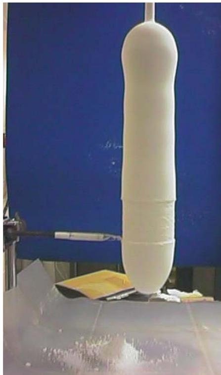
**Figura 3-13.** Processo de “usinagem” da preforma porosa, Sekiya (2001).
