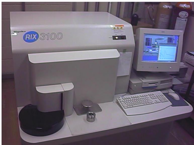
**Figura 3-24.** Equipamento de espectrometria de fluorescência de raios-X.
