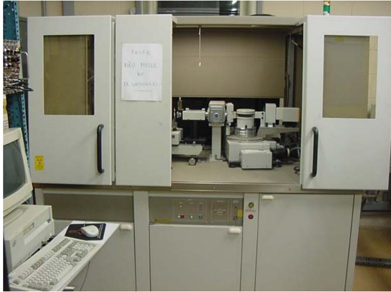
**Figura 3-25. Equipamento de difração de raios-X (DMAX 220).**
