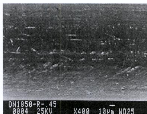
Figura 7 – Qualidade superficial do fio Ø 0,45 mm - recozido óleo Honilo 171 – fieira 3
