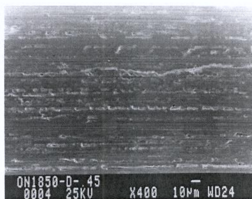
Figura 4 – Qualidade superficial do fio Ø 0,45 mm - encruado óleo Honilo 171 – fieira 3
