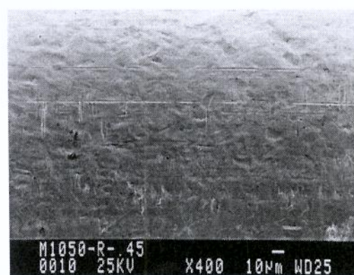
Figura 8 – Qualidade superficial do fio Ø 0,45 mm - recozido óleo Honilo 171 – fieira 9
