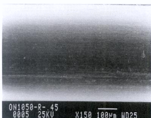
Figura 7 – Qualidade superficial do fio Ø 0,45 mm - recozido óleo Honilo 171 – fieira 3
