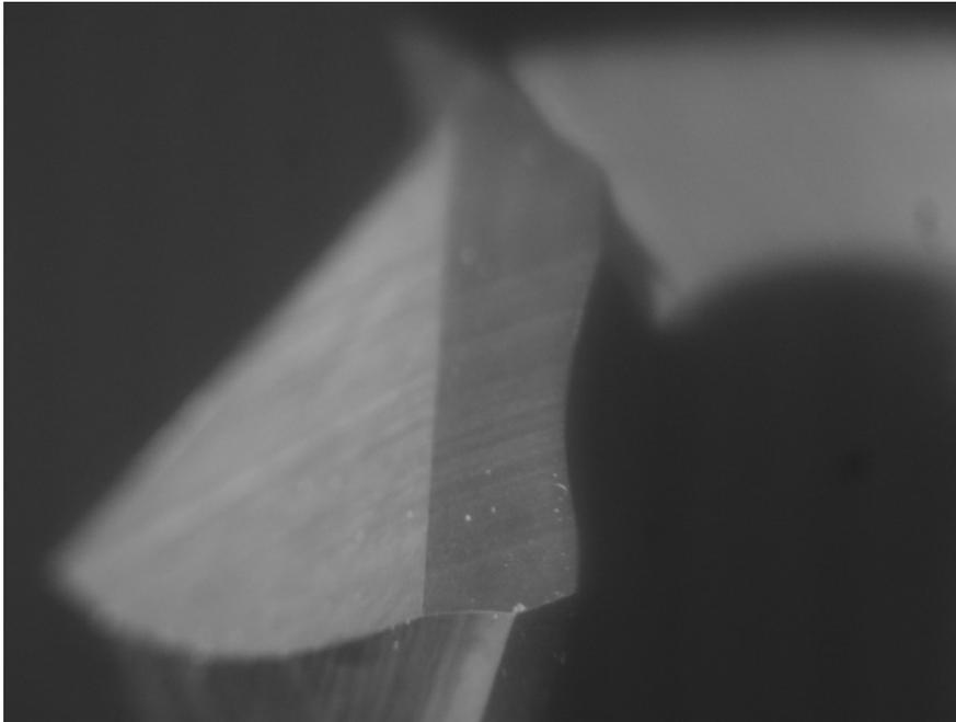
Figura 5.4 – Fotografia mostrando aresta de corte e superfície principal de folga da broca usada.
