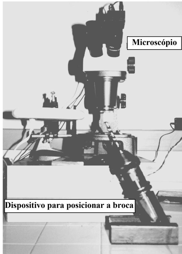
Figura 5.13 - Montagem do sistema de medição do desgaste da broca.
