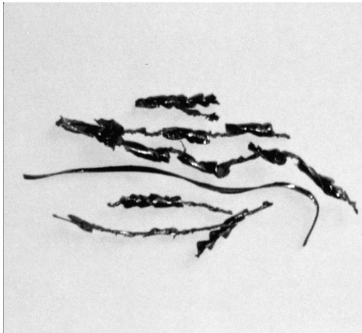
Figura 6.14 – Forma dos cavacos **a)** no início e **b)** no fim dos ensaios sem fluido de corte.
