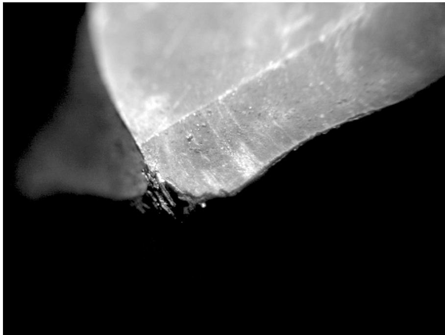
Figura 6.5 - **a**) aresta de corte na ferramenta nova e **b**) desgaste típico após 645 furos no ensaio 2.
