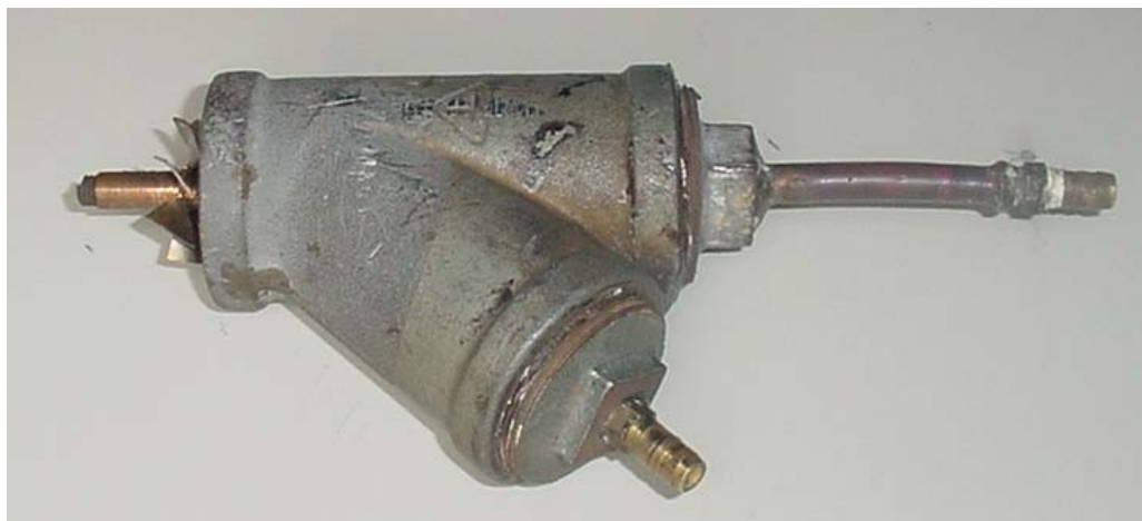
Figura 5. 7: T de 45 °usado para misturar os gases
