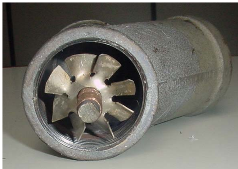
Figura 5. 8: Promotor de turbulência dos gases
