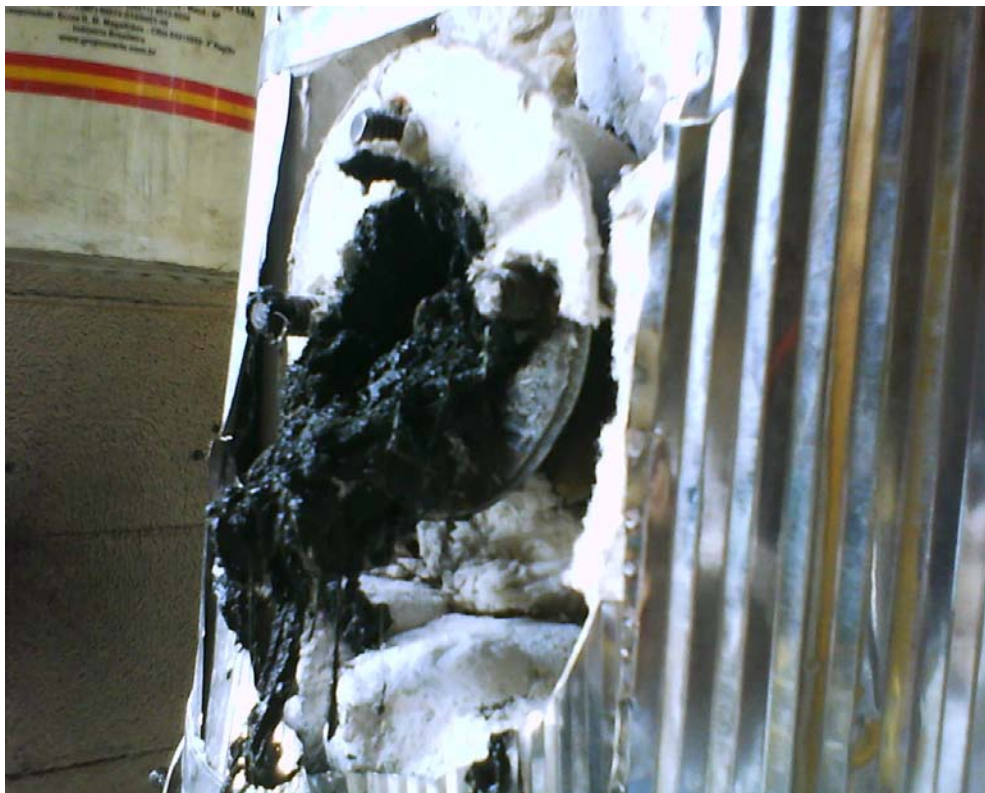
Figura 4.14 – Poliamida derretida misturada à areia no bocal de alimentação do reator.
