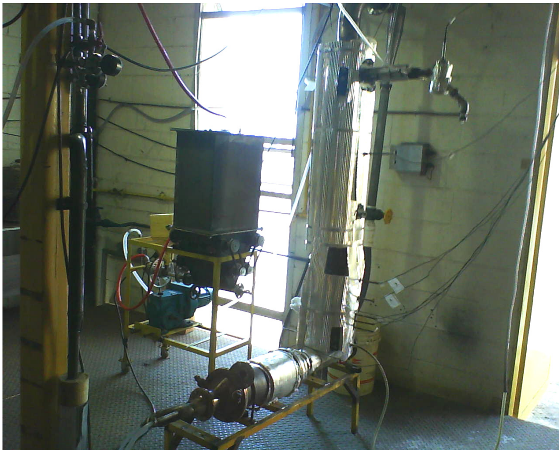
Figura 4.4 – Reator de leito fluidizado utilizado.
