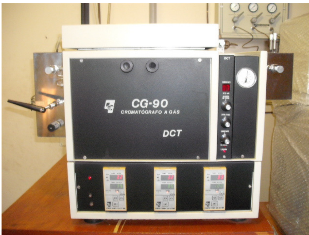
Figura 4.7 – Foto do cromatógrafo utilizado nos ensaios de pirólise de PA-12.
