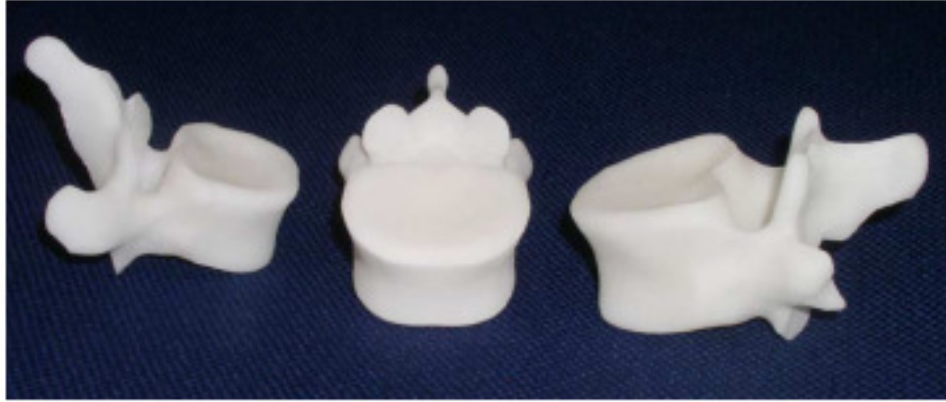
Figura 3.19 – Vértébras ósseas reproduzidas por SLS (Lohfeld et al, 2005).
