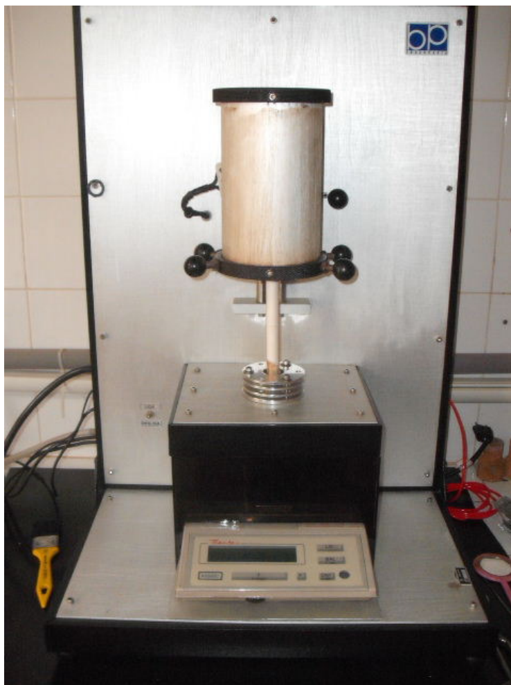
Figura 4.2 – Foto da balança termogravimétrica utilizada.
