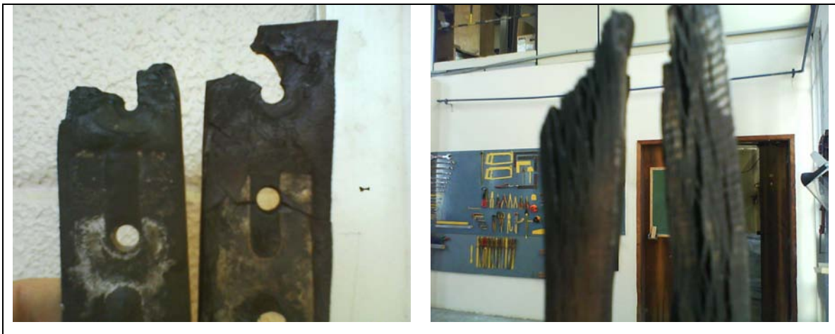
Figura 4.13 – Imagem das placas de celeron danificadas.
