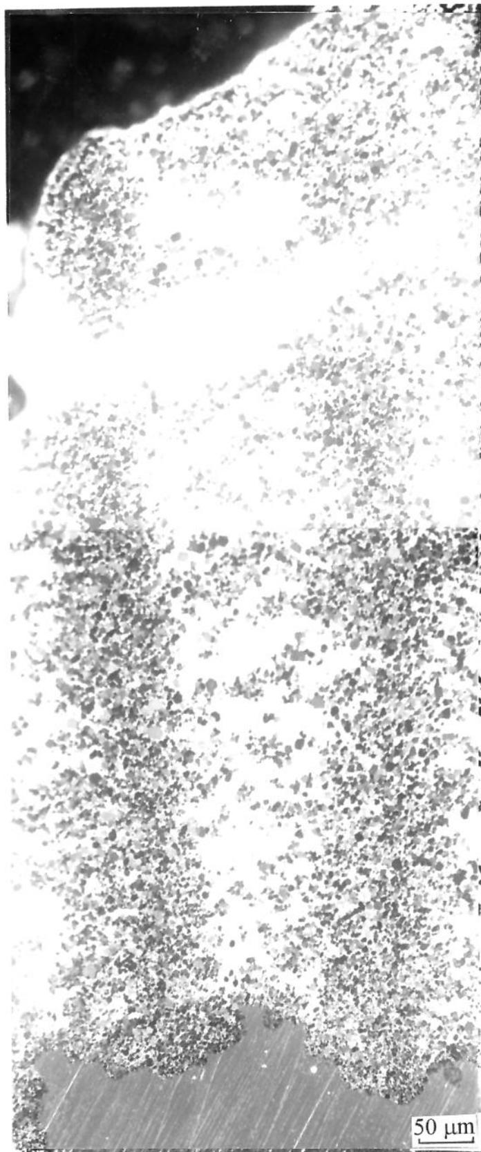
**Figura 5.9** - Região rica em partículas intermetálicas da lâmina de Nb ensaiada a 950°C, por 4,0h.
