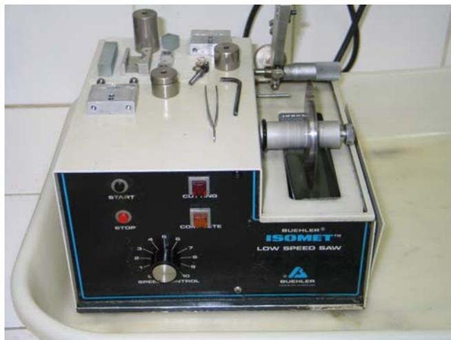
Figura 22 – Cortadeira modelo ISOMET fabricante Buehler.
