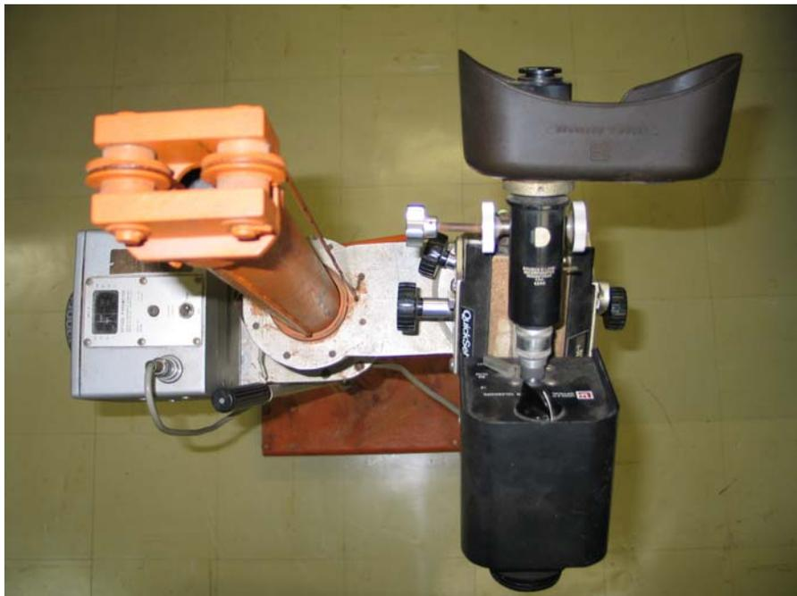
Figura 18 – Pirômetro ótico modelo QuickSet fabricante Leeds & Northrup Company
