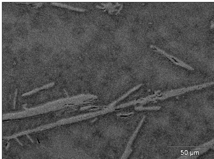
Figura 37 – Micrografia da liga Fe<sub>56</sub>Co<sub>7</sub>Ni<sub>7</sub>Zr<sub>10</sub>B<sub>20</sub> na região grossa.
