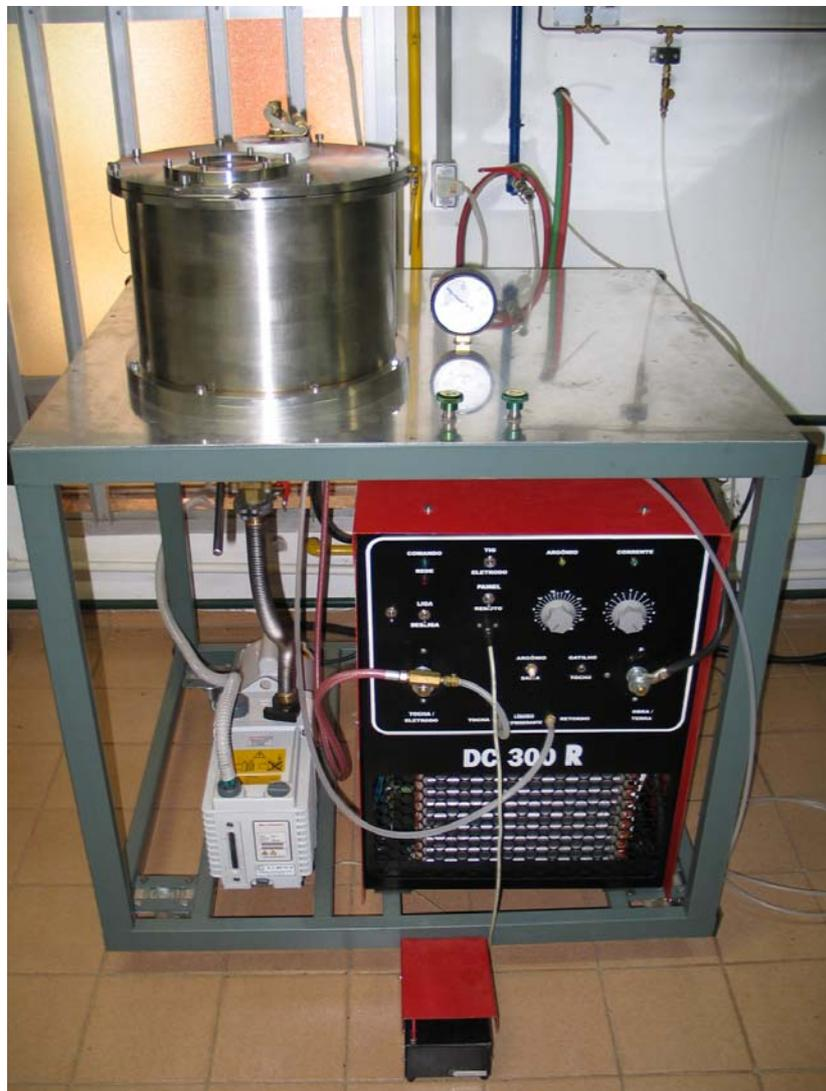
Figura 19 – Centrífuga para fusão de ligas desenvolvida no LMFS-FEM
