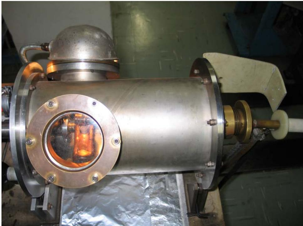
Figura 14 - Câmara do forno de fusão a arco construído no GPCM.
