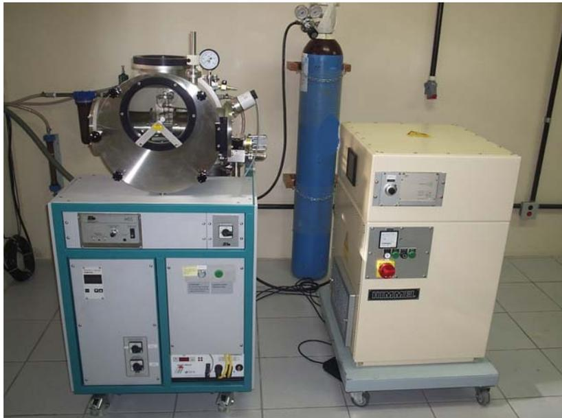
Figura 21 – *Splat-Cooler* modelo MSS fabricante Edmund Bühler
