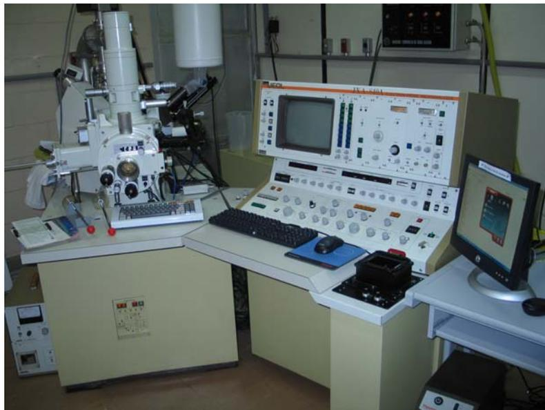
Figura 27 – Microscópio eletrônico de varredura modelo 4XA-840A fabricante JEOL
