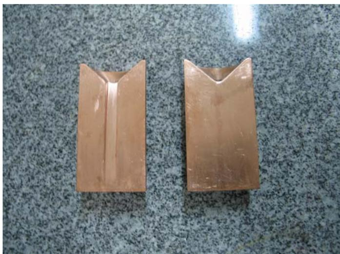
Figura 20 – Molde em forma de cunha de cobre utilizado na centrífuga.
