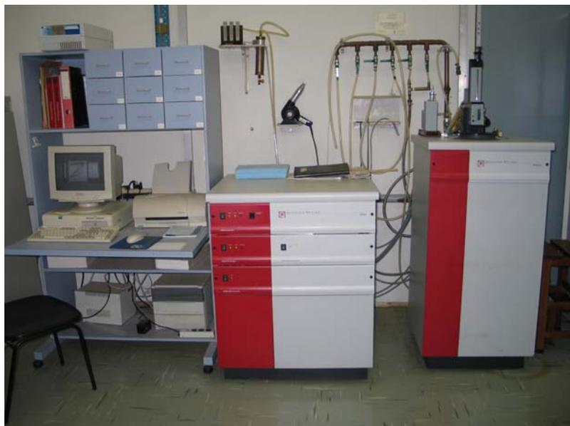
Figura 31 – SQUID modelo MPMS XL7 fabricante Quantum Desing
