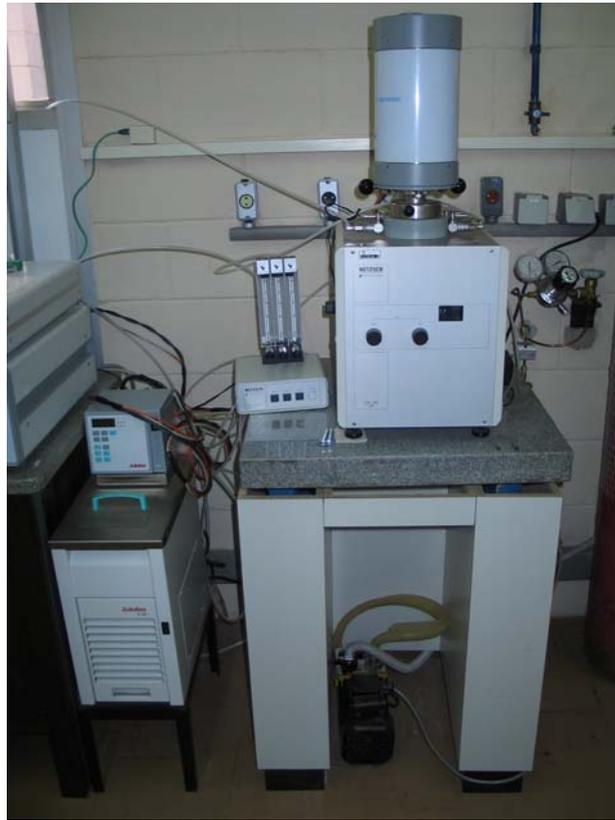
Figura 29 – Calorímetro modelo STA409/Cell fabricante NETZSCH
