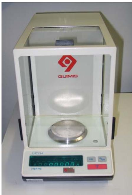
Figura 13 - Balança digital Modelo LAC 214 com precisão de 0,1 mg.
