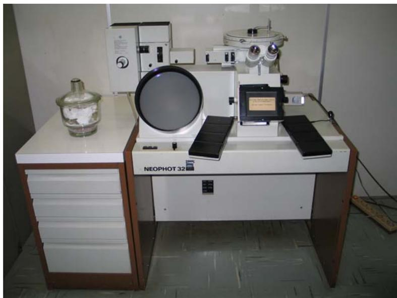
Figura 26 – Microscópio ótico modelo NEOPHOT 32 fabricante Carl Zeiss
