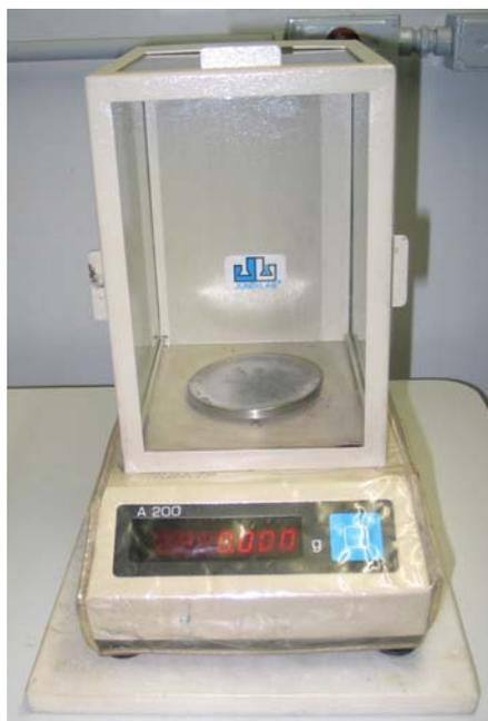
Figura 12 - Balança digital Modelo A 200 com precisão de 1 mg.
