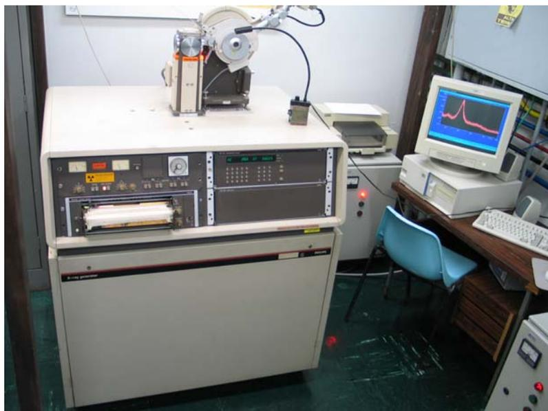
Figura 28 – Difrator de raios-X modelo PW 1730-10 fabricante Philips.
