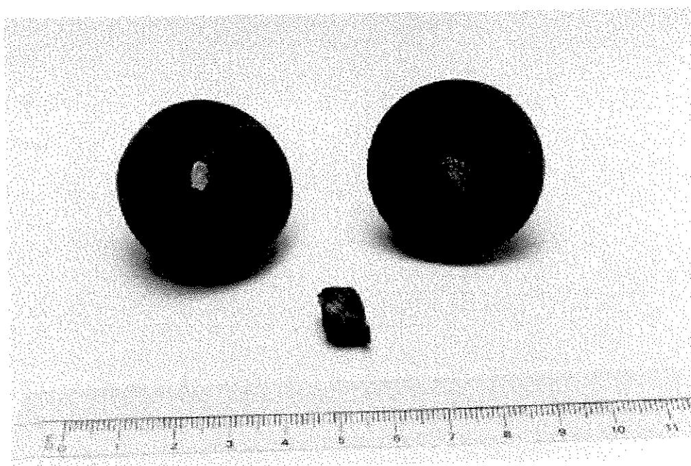
Figura 5.37. Amostra obtida após ensaio de compressão a quente (1000°C) com matriz confeccionada com a liga inonel 718, e gráfico tensão  $\times$  deformação.
