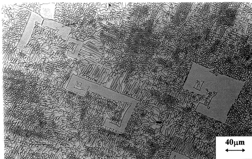
Figura 5.26. Detalhe da seção transversal da amostra solidificada direcionalmente, velocidade de solidificação de 30 mm/h.
