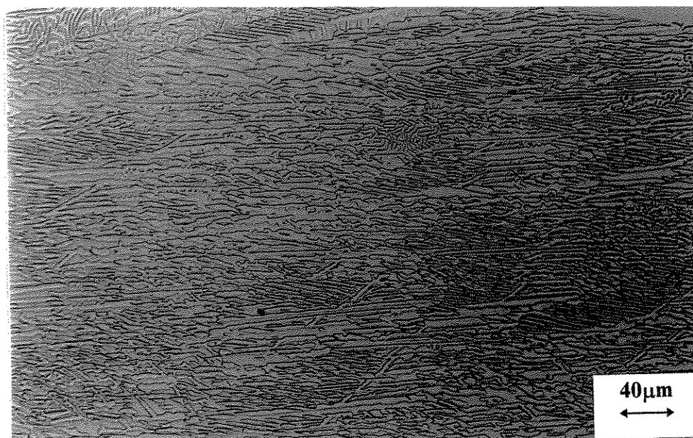
Figura 5.27. Detalhe da seção transversal da amostra solidificada direcionalmente, velocidade de solidificação de 30 mm/h.
