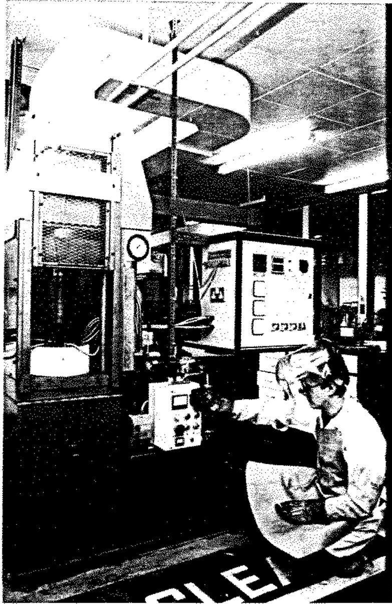
Figura III.3 - Equipamento de infiltração para a produção do compósito utilizado (Laboratórios do Chemycal and Polymer Group, ICI, Runcorn, Inglaterra).
