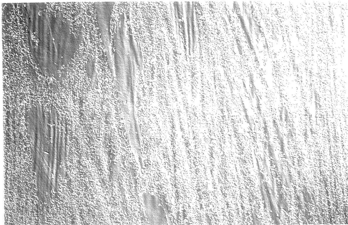
Figura 4.7 Micrografia ótica da barra forjada da liga CrNi mostrando recristalização parcial, aumento: 125X, ataque: Glicerégia. (14/0484)
