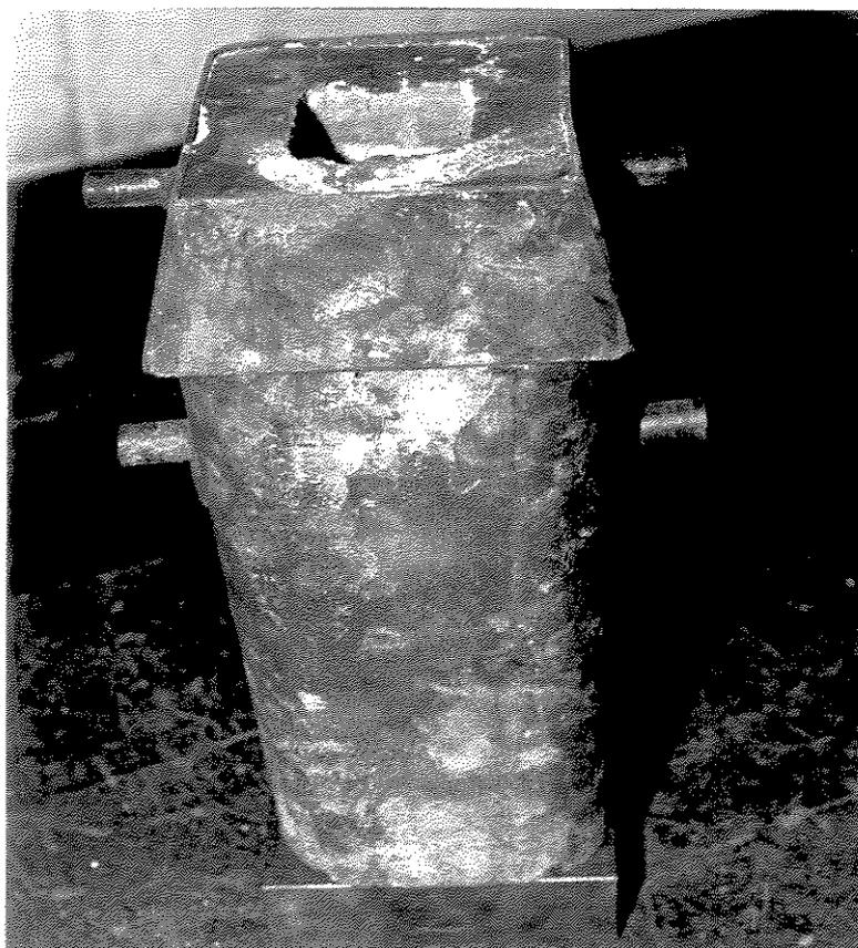
Figura 4.3 Lingoteira montada, pronta para ser colocada na câmara de fusão.
