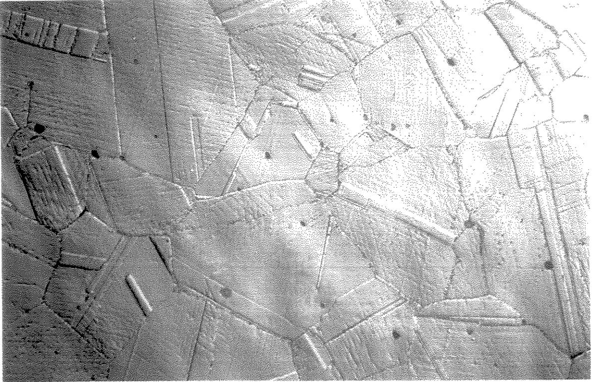
Figura 5.40 Liga CrNiCo, AM25, após 3 ciclos a 680 °C + 3 ciclos a 630 °C, mostrando precipitação de carboneto de cromo em contorno de grão, ataque: Glicerégia; aumento: 500X (24/0484)
