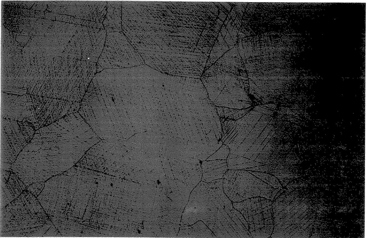
Figura 5.41 Ídem acima, ataque eletrolítico com ácido oxálico, aumento: 500X (0855)
