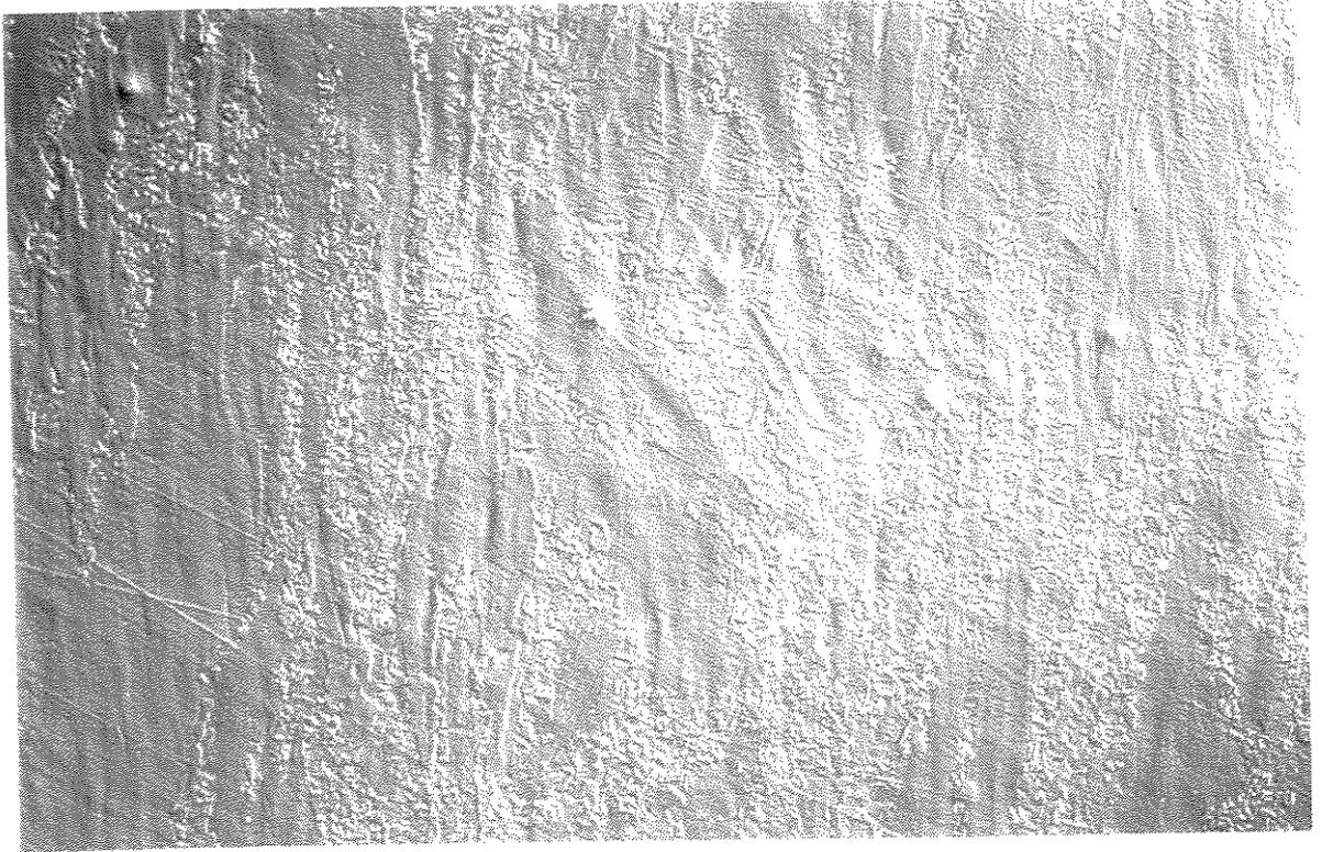
Figura 4.9 Micrografia ótica da barra forjada da liga CrNiCo mostrando recristalização parcial, aumento: 125X, ataque: Glicerégia. (6/0484)
