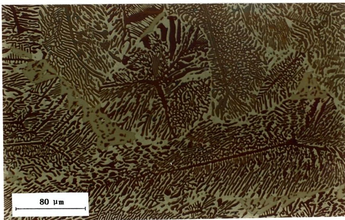
Figura 4.44 - Amostra Al 54 Cr 34 Nb 12 Tratada a 1000°C por 1 mês.
