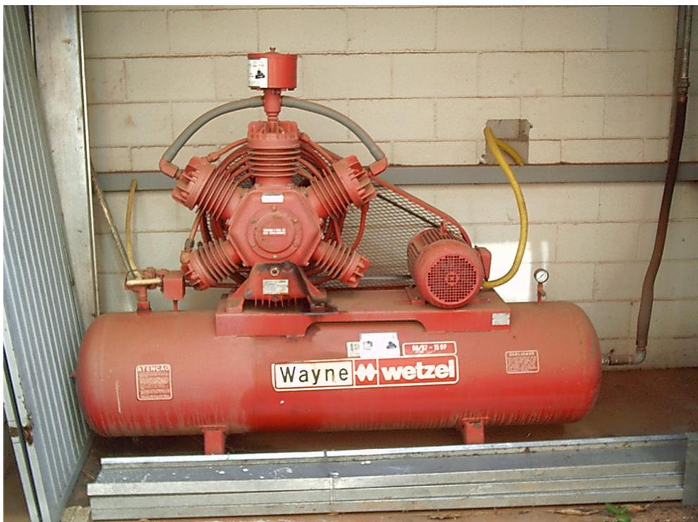
Figura 3.5: Compressor usado na compressão da fase gasosa.
