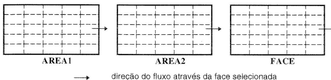
**Fig. 7.14 - Esquemas a montante do fluxo considerados no cálculo da saturação equivalente, num subdomínio 5x5**
