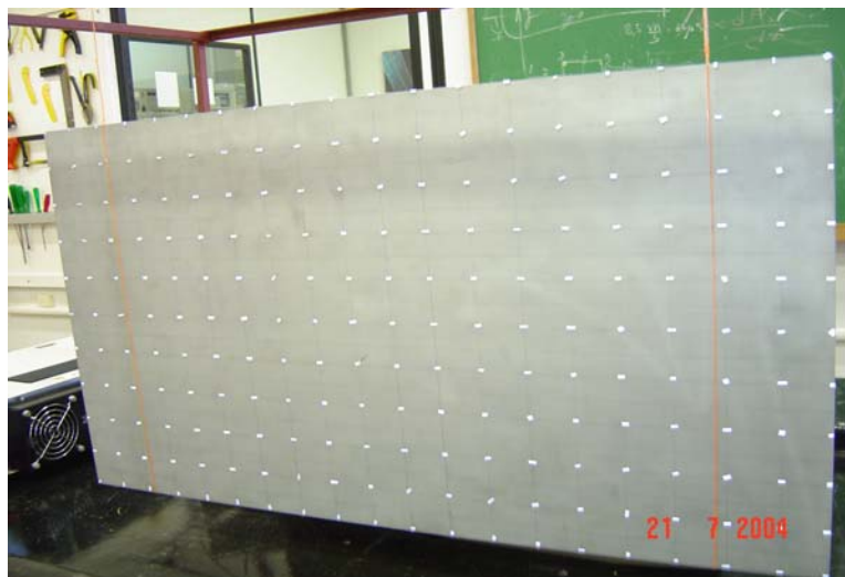
Figura 4.4 - Foto do painel com os pontos medidos.
