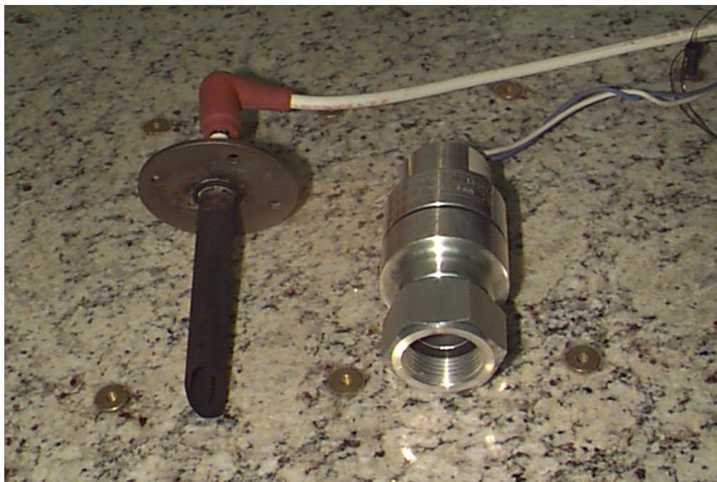
Figura 3.30 Eletrodo de ignição e sensor de chama
