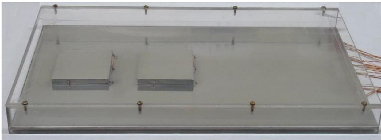
**Figura 3.8.** Duto de acrílico com a placa inferior de alumínio.
