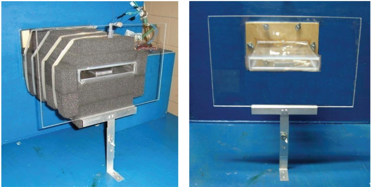
**Figura 3.2.** Placa frontal de acrílico na entrada do duto.
