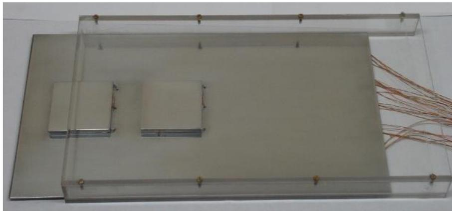
**Figura 3.3.** Montagem da placa de alumínio no duto com paredes de acrílico.
