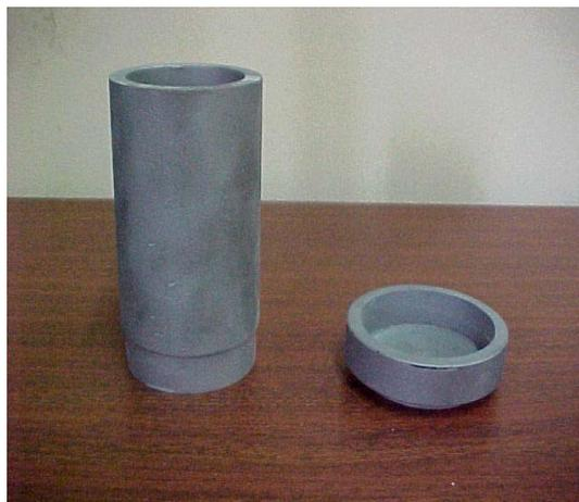
**Figura 4.5** - Lingoteira em aço inox e chapa/molde partes integrantes do sistema de solidificação unidirecional.
