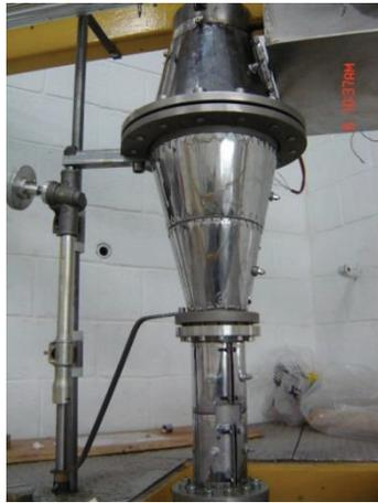
**Figura 3-9 –Câmara com resistências elétricas para o aquecimento**
