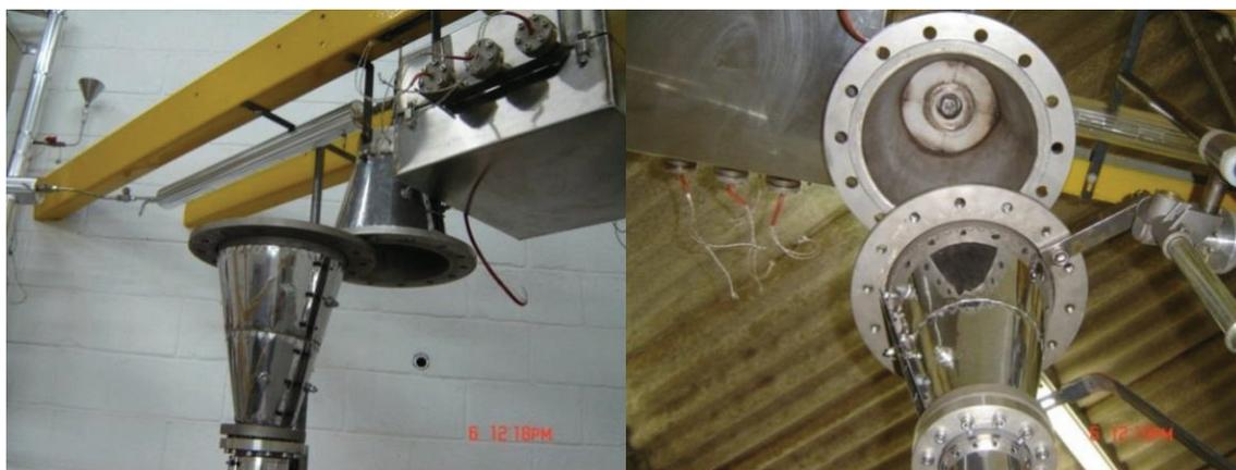
Figura 3-8 – Câmara de reação deslocada para inspeção
