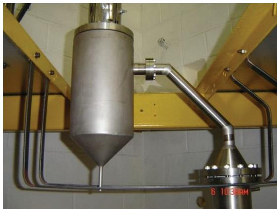
**Figura 3-10 – Condensador 1**
