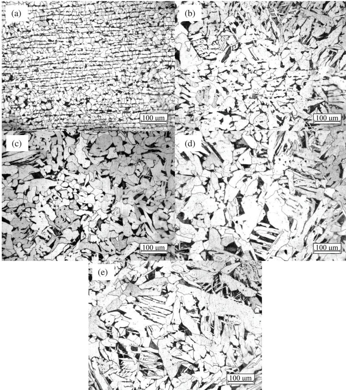
Figura 4.11 – Micrografia dos CPs “A” após tratamento térmico à (a) 900°C, (b) 1000°C, (c) 1050°C, (d) 1100°C e (e) 1200°C (ataque com Nital 2%) – 2º Teste.
