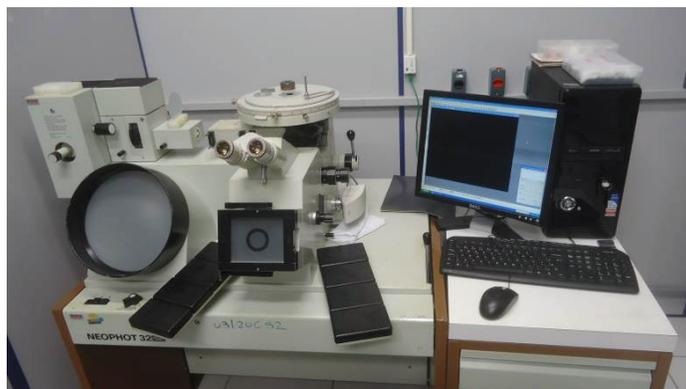
Figura 3.11 – Microscópio óptico.
