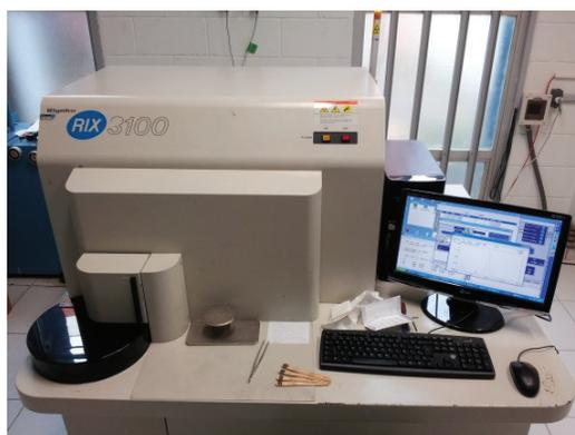
Figura 3.12 – Espectrômetro de fluorescência de raios-X.
