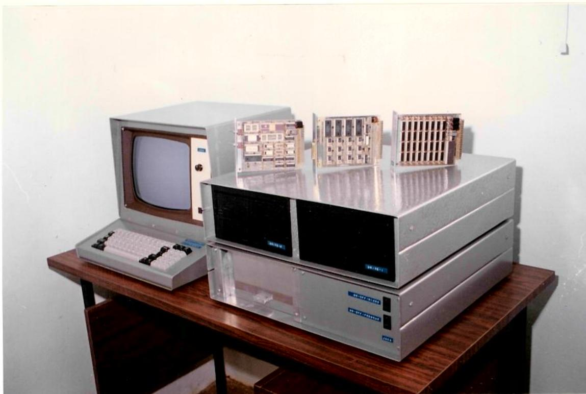
Figura (4.1) - Fotografia do Sistema Microcomputador PROEN, onde pode ser visto o Terminal de Vídeo Alfanumérico, os dois Acionadores de Discos Flexíveis, o Microcomputador e algumas placas constituintes do Sistema.
