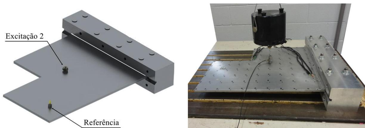
**Figura 5.115 – Posição da excitação harmônica e referência placa engastada**
