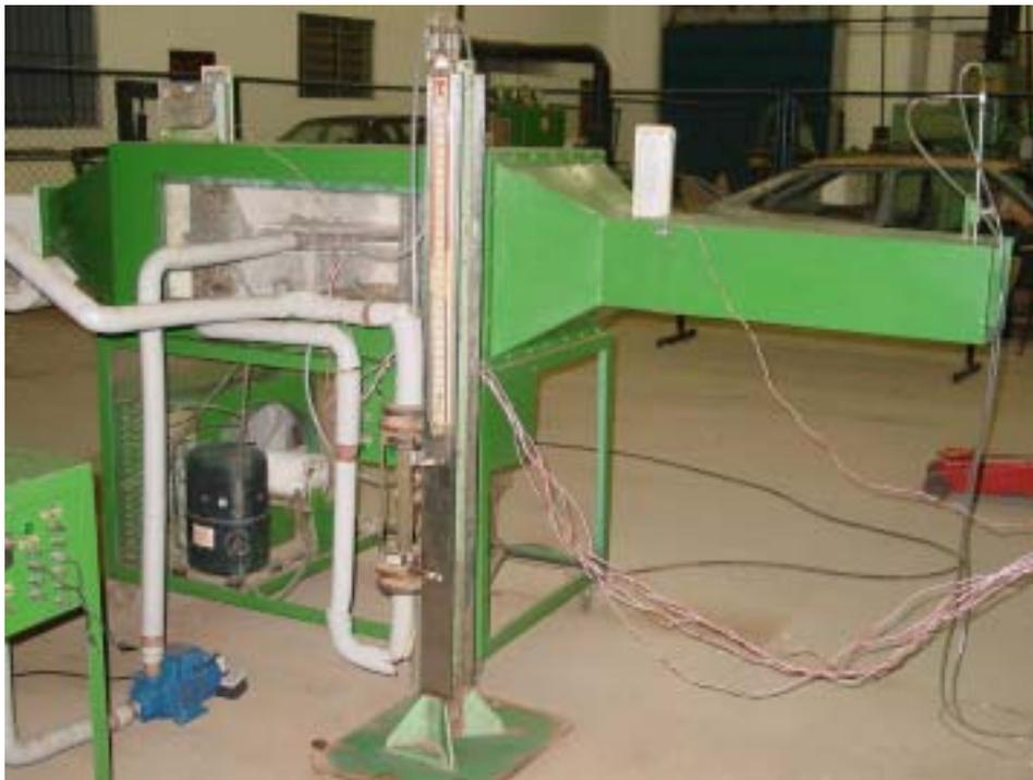
Figura 3.3 – Bancada de ar condicionado
