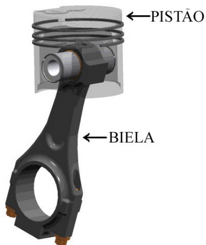
Figura 1.1: Ilustração do sistema formado por um pistão e uma biela
