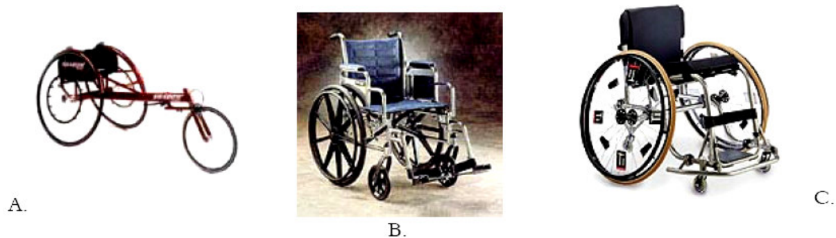
Figura 5.3 - Ilustração de diferentes diâmetros dos aros de propulsão de cadeira de rodas. (A) corrida (B) padrão e (C) basquete.
