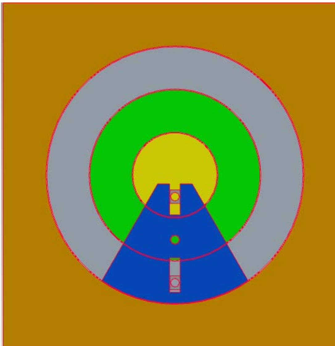
7.2 – Sistema mecânico de embreagem seletiva: base, discos e cunhas
