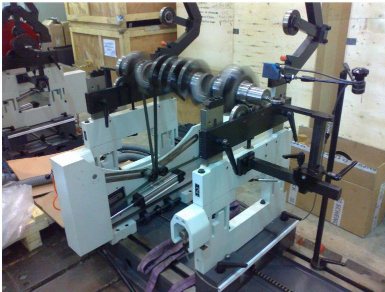
Figura 2.1: Máquina de balancear rotor, utilizada no balanceamento de protótipo de virabrequim.
